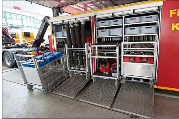
Abb. 55: Verpackung in Form von fahrbaren Kleinrollcontainern und multifunktionalen Logistikfahrzeugen im Euro-Maß
