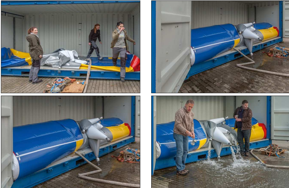
Abb. 52: Test zweier aus drei Schläuchen mit Befülltüben bestehender Segmente im Testcontainer, Betriebshof DAEDLER
