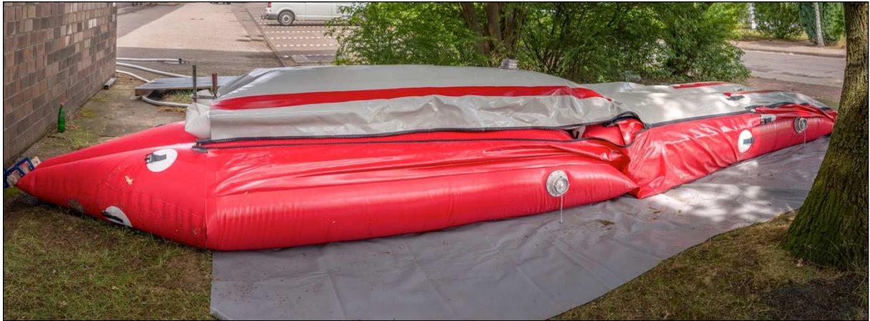
Abb. 54: Labormodell Doppelkammerschlauch teildurchlässiger Mittelnaht mit aufgelegtem dritten Schlauch, Betriebsgelände DAEDLER
