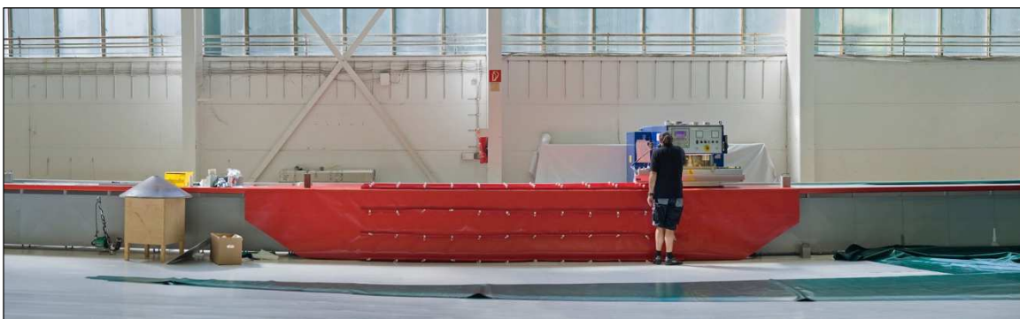
Abb. 48: Hochfrequenzschweißen der Innenkonstruktion der Außenhülle der trapezförmigen Behälterkonstruktion mit Haltetaschen für Karabinerhaken, Produktionshalle DAEDLER
