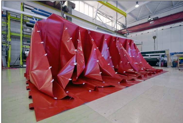
Abb. 49: Konfektion des trapezförmigen Behälters hinsichtlich der Herstellung der inneren Haltekonstruktion, Produktionshalle DAEDLER
