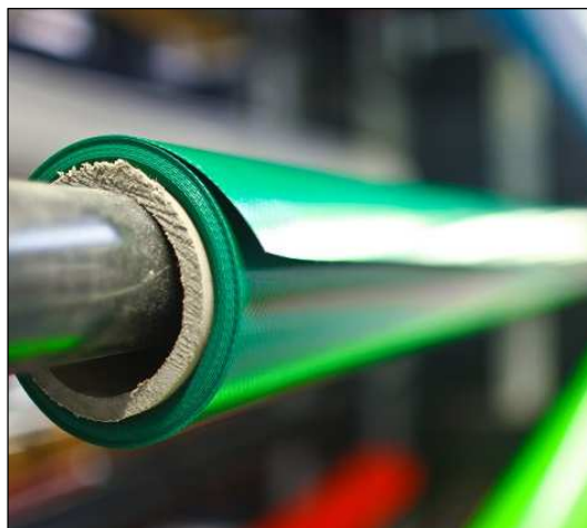
Abb. 44: PVC beschichtetes PES Gewebe mit einer Festigkeit von mindestens 3800/3800 N auf 5 cm
