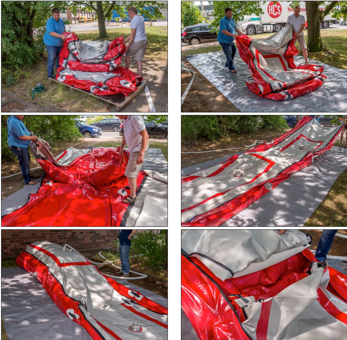
Abb. 53: Labormodell Doppelkammerschlauch mit teildurchlässiger Mittelnaht, Betriebsgelände DAEDLER
