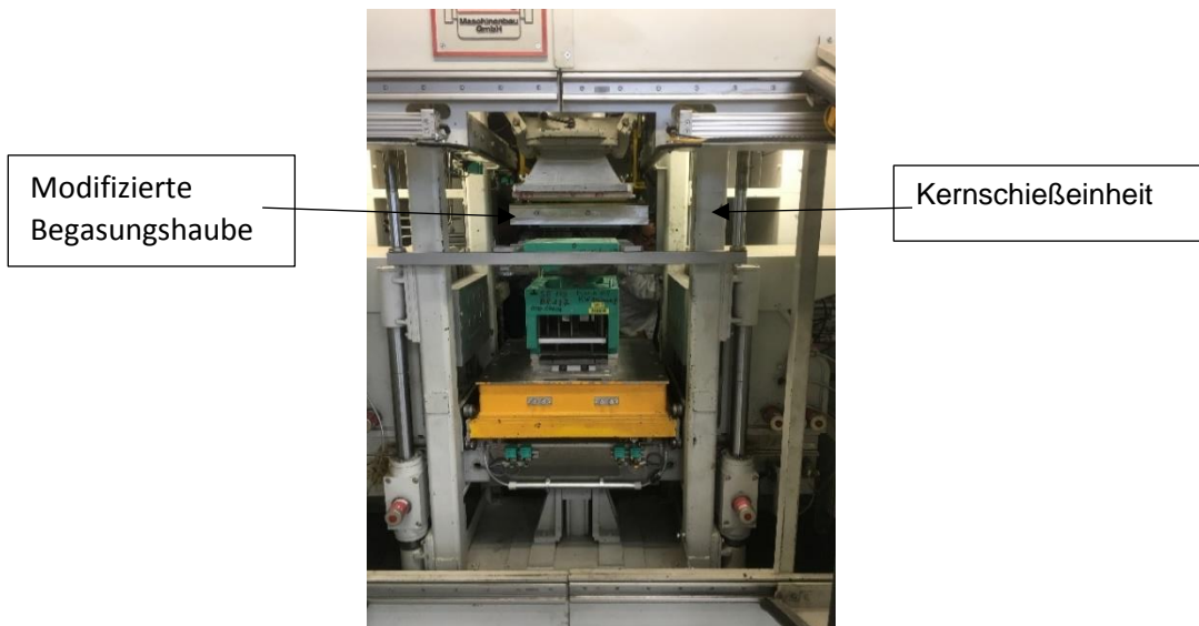
Kernschießmaschine mit der modifizierten Begasungshaube und Werkzeug, Bild 21
