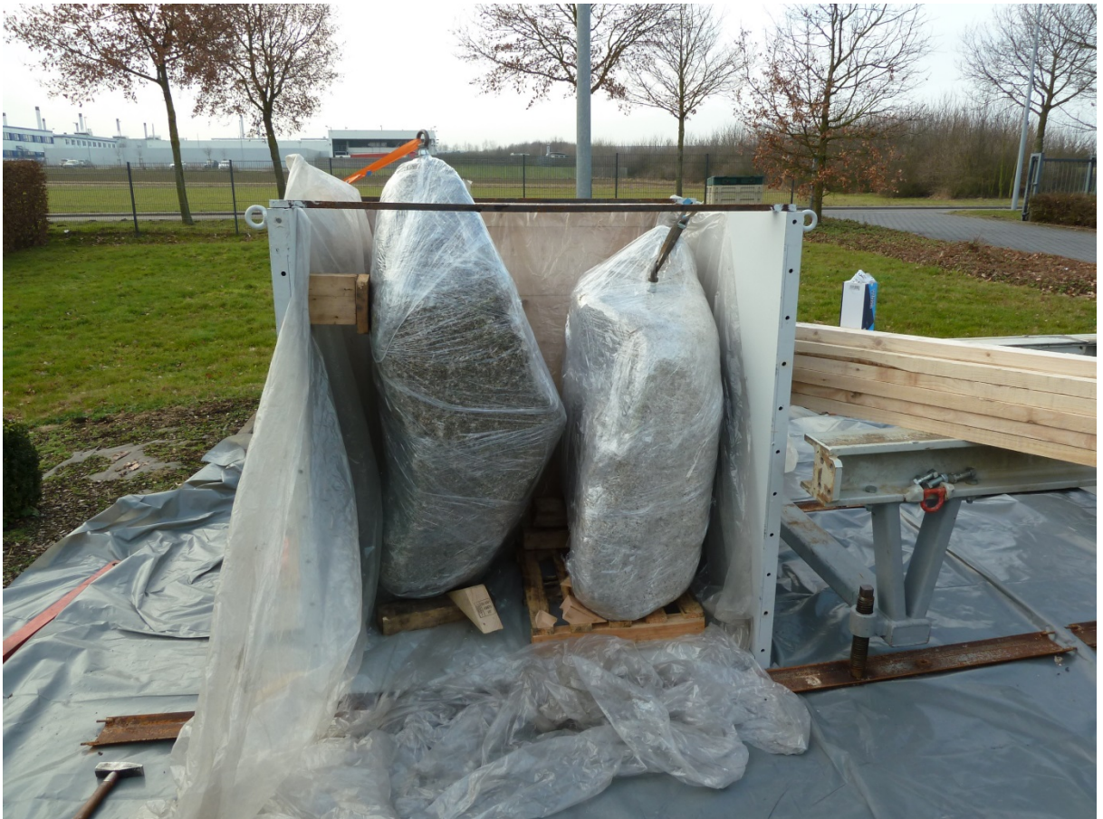
Abbildung 1: Versuchskasten mit Findlingen vor Verfüllung mit Beton
