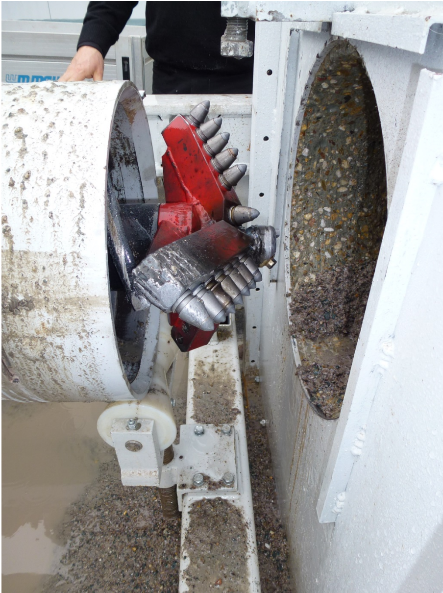
Abbildung 4: Feststehender Bohrkopf mit modifiziertem Vorbohrer
