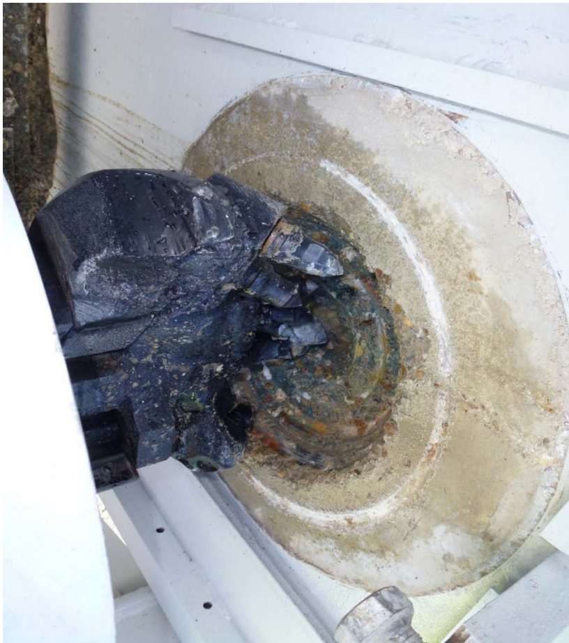
Abbildung 2: Klappbohrkopf bei der Einfahrt
