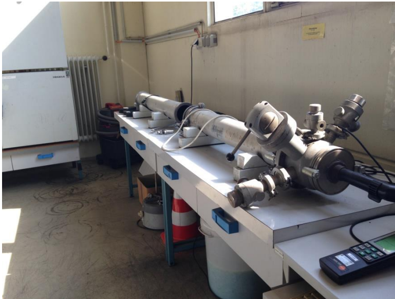
Abbildung 19: Prüfaufbau für die Bestimmung der Luftdurchlässigkeit von Filtermedien.
