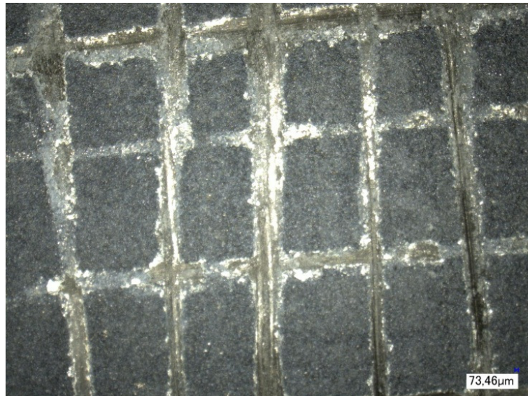
Abbildung 2: Probe D119_CFK12 mit Zinkhaftgrund und einem Gemisch aus Al 2 O 3 und TiO 2 im Gitterschnitt: Nur minimale Abplatzungen, gute Haftung zum CFK-Untergrund und gute Kohäsion der thermischen Spritzschichten
