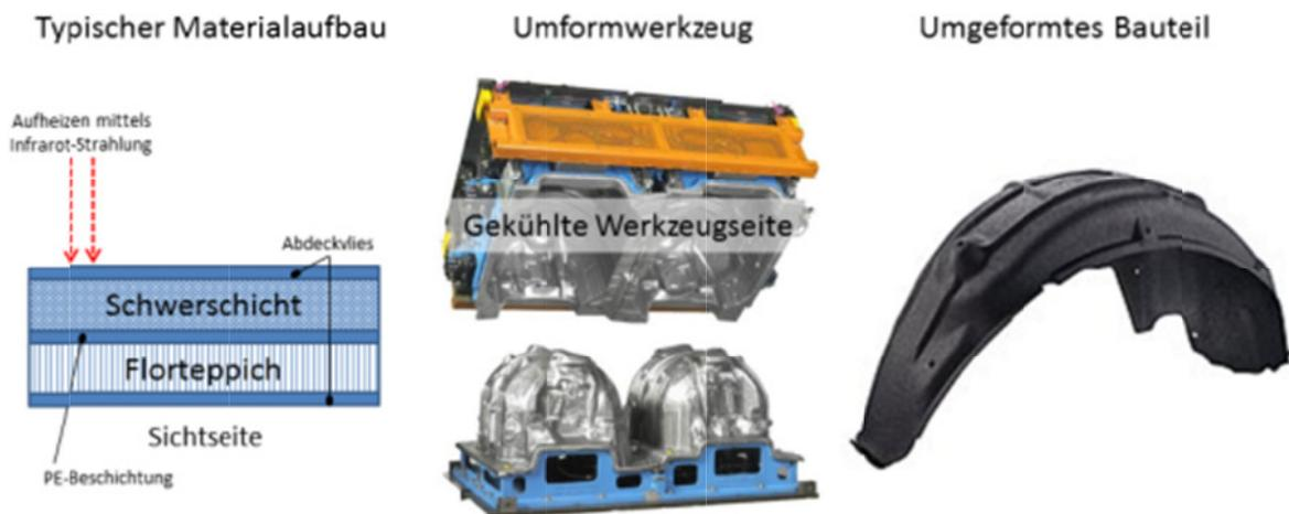
Abbildung 1: Beispielhafter Prozess zur Herstellung eines Teppich-Einbauteils (am Beispiel einer Radhausverkleidung)
