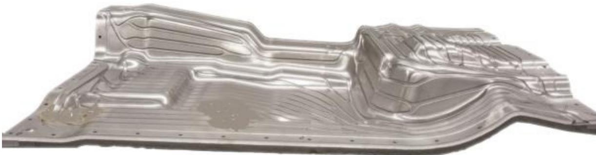
**Abbildung 13: Fertiggestellte Konturschale mit rückseitig gefrästen Kanälen (die Konturseite liegt in der Abbildung unten)**
