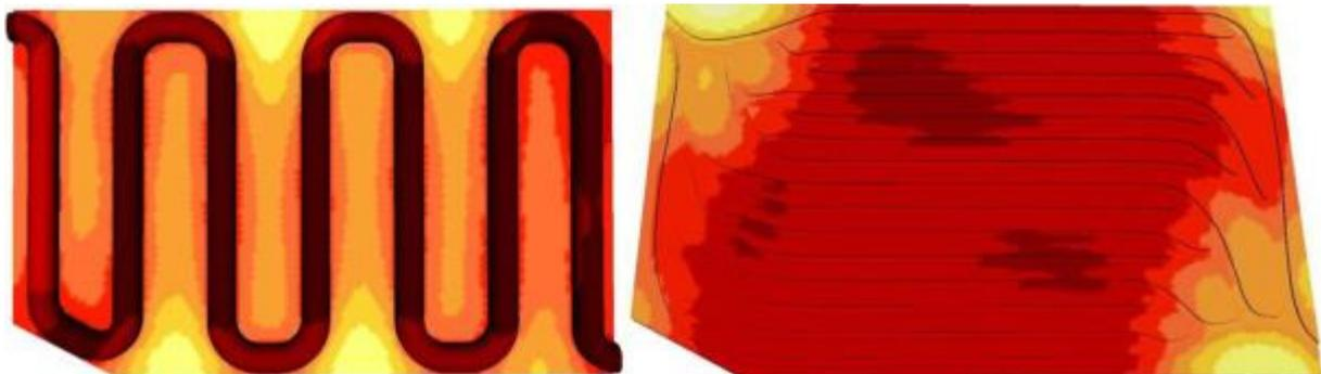
**Abbildung 41: Darstellung der Werkzeugflächen in der Finite-Elemente-Software (links konventionelle Kanalstruktur, rechts FracTherm®-Kanalstruktur)**
