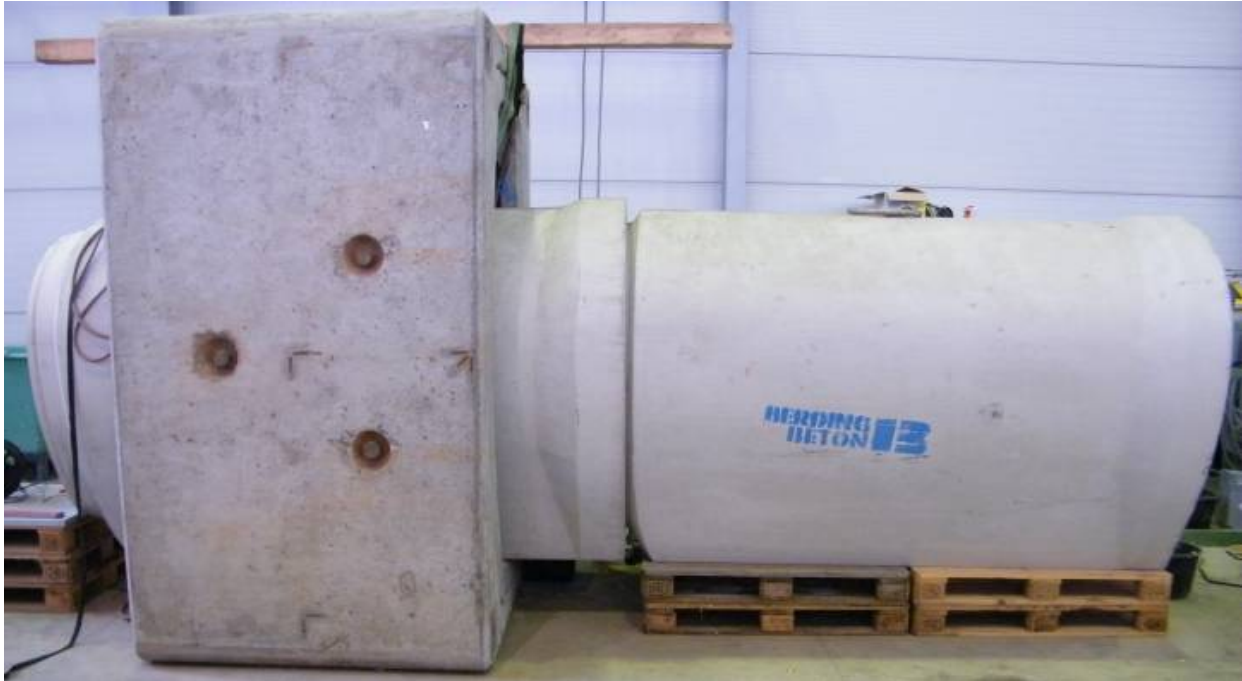
Bild 37 Teststrecke mit Stahlbetonrohren im IKT: Bereich mit Bettungssimulation links im Bild
