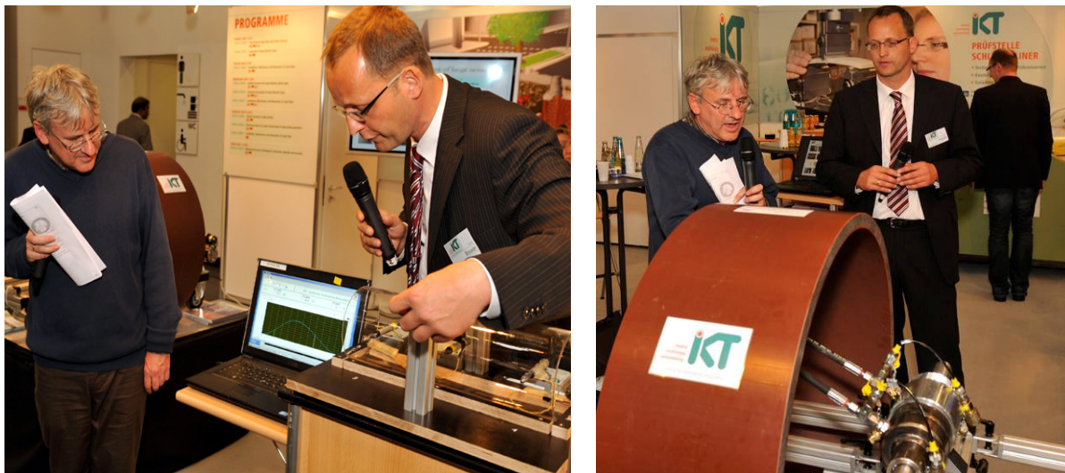
Bild 51 Bert Bosseler, IKT, (links), demonstriert dass mit der Messtechnik der MAC-Prüfeinrichtung auch in Glasrohren Verformungen und Steifigkeiten direkt messbar sind und Olivier Thépot, Eau de Paris, (rechts) erläutert die Funktionsweise der MAC-Prüfeinrichtung anhand eines 1:1-Prototypen
