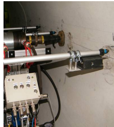
Bild 38 Abstände von d0, d1 und d2 zur Druckzylindermitte (links) und Positionierung der Wegmessmodule d0, d1 und d2 (rechts)
