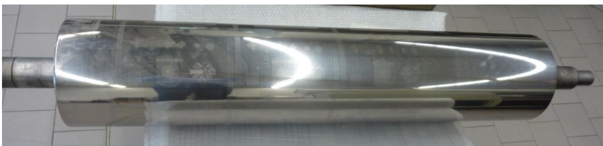
Abb. 31: Gravierter Tiefdruckzylinder mit ns-Laser
