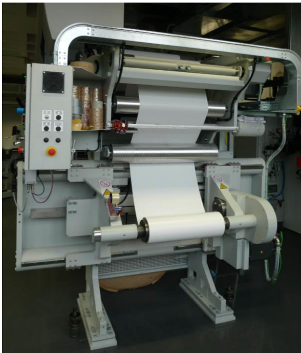
Abb. 49: Substrat-Zuführstation der Druckmaschine
