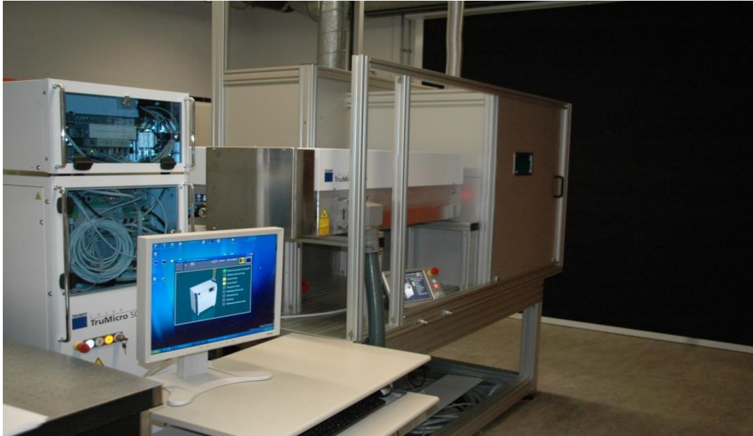
Abb. 3: Pikosekunden-Laser Typ „TruMicro 5050“ mit Bearbeitungskammer beim Projektpartner Laserzentrum (LFM)
