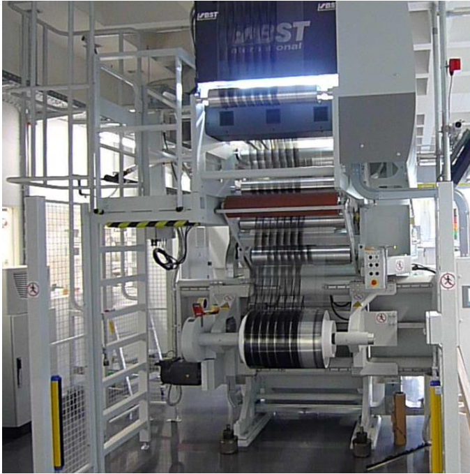
Abb. 50: Substrat-Aufrollstation der Druckmaschine
