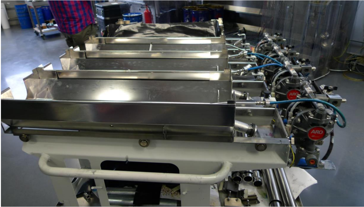
Abb. 44: Farbwanne mit Farbpumpe
