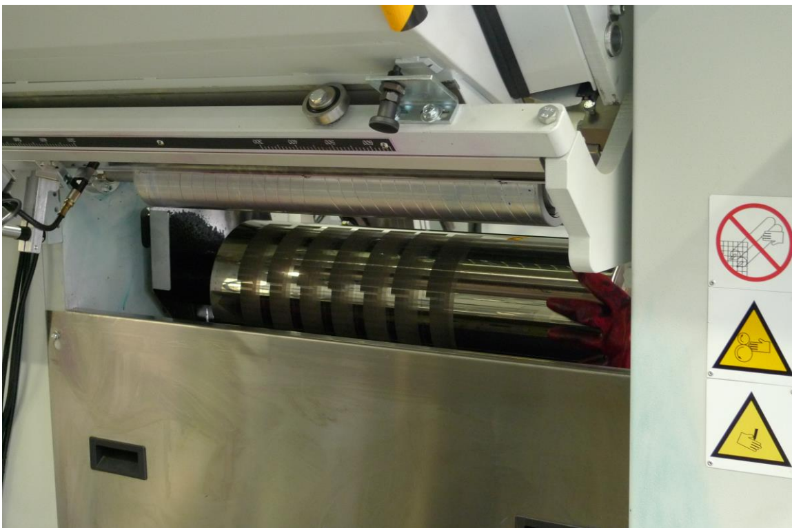
Abb. 47: Zylinder in Farbwerk
