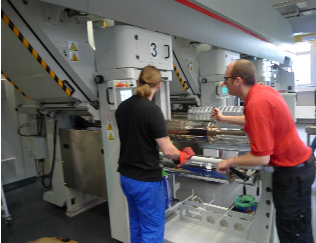
Abb. 46: Einbringen des Zylinders in ein Farbwerk
