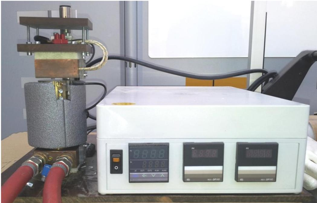
Abb. 2: Versuchsaufbau nach DIN 51908
