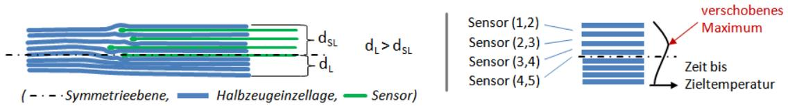
Abb. 27: Beeinflussung der Messergebnisse durch Thermoelemente infolge vergrößerter Lagenabstände
