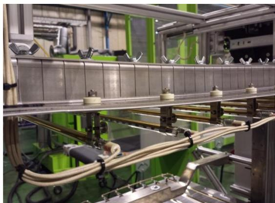
Abb. 23: Detailansicht IR-Strahlerfeld (links) und Winkelverstellung über geschlitztes Blech mit Flügelmutterhalterung (rechts)
