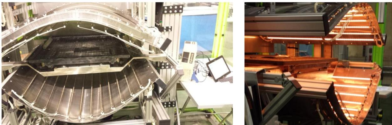
Abb. 24: Temperierstation im Versuchsssetup (links), mit eingeschalteten IR-Feldern (rechts)
