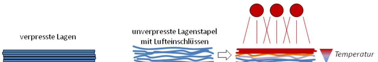
Abb. 4: Unterschiedliche Bedingungen für die Erwärmung in Abhängigkeit vom Halbzeugaufbau
