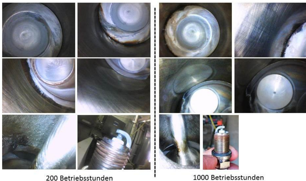
ABBILDUNG 31 ZWISCHENBEFUNDUNG BRENNRAUM NACH 200 UND 1000BH
