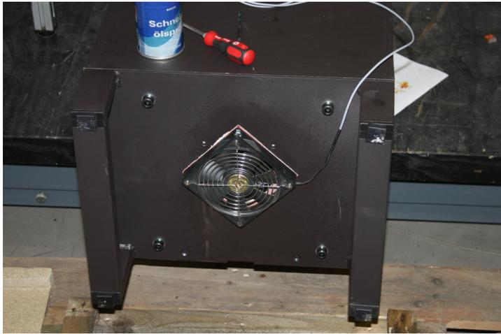
Abbildung 34: Aufbau des Gebläses zur Sekundärluftversorgung unter dem Fußteil
