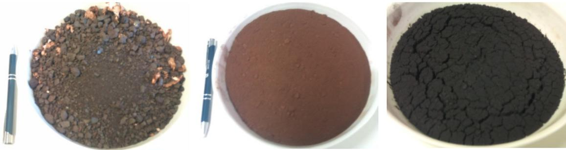
**Abbildung 3: Getrocknete Metallhydroxid-Mischung (li.) nach dem Mahlen (mi.) und als kalziniertes Pulver (re.)**
