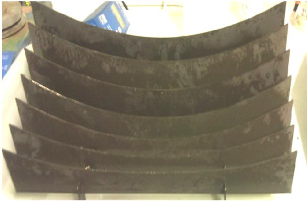
Abbildung 8: Brüniertes TwinFire-Gate nach der Beschichtung mit Nickelnitrat-Lösung
