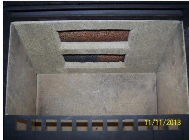
**Abbildung 29: Fotos des neu konstruierten Kaminofens mit vergrößertem Brennraum unten und getrennter Sichtscheibe**
