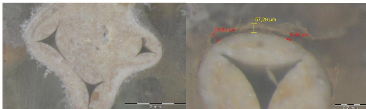
**Abbildung 11: Lichtmikroskopische Aufnahmen vom Querschnitt des gealterten Wandkatalysators**
