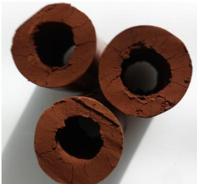
**Abbildung 6: Nichtkalzinierte Rohre aus 75 Ma.-% Nickelferrit mit einem Durchmesser von 25 mm**
