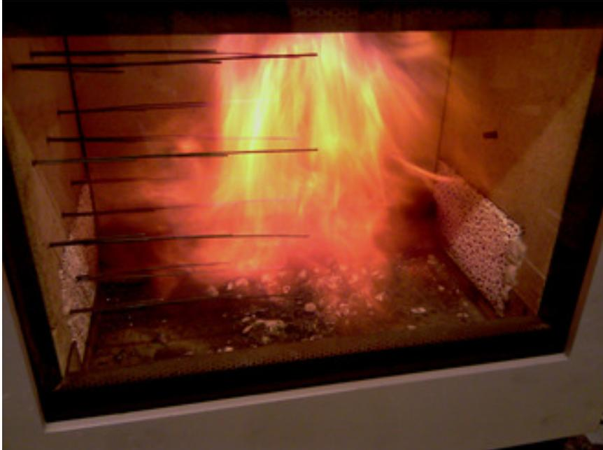
Abbildung 23: Fotografie des Versuchsaufbaus mit unbeschichteten  $\text{Al}_2\text{O}_3$ -Schwämmen im unteren Brennraum
