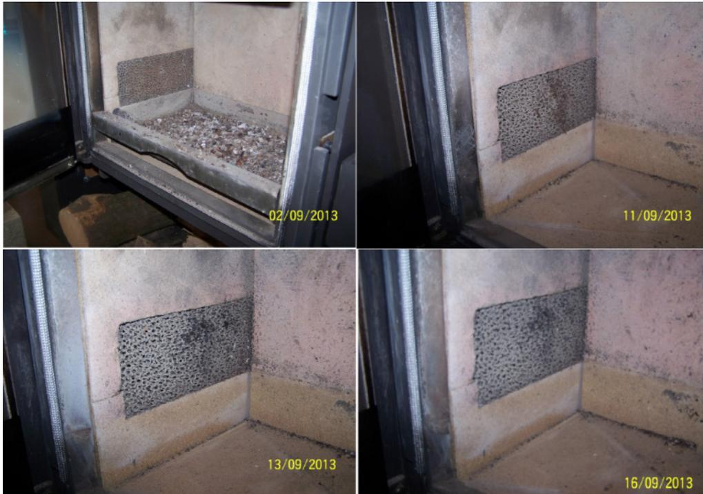
**Abbildung 26: Ausgewählte Fotos der Wandkatalysatoren bei der durchgeführten Alterung unter Praxisbedingungen (Vorführkaminofen der Firma Specht) für 728 h reale Betriebszeit**
