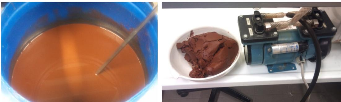
Abbildung 2: Metallhydroxide in Mutterlauge (li.) und nach der Filtration (re.)
