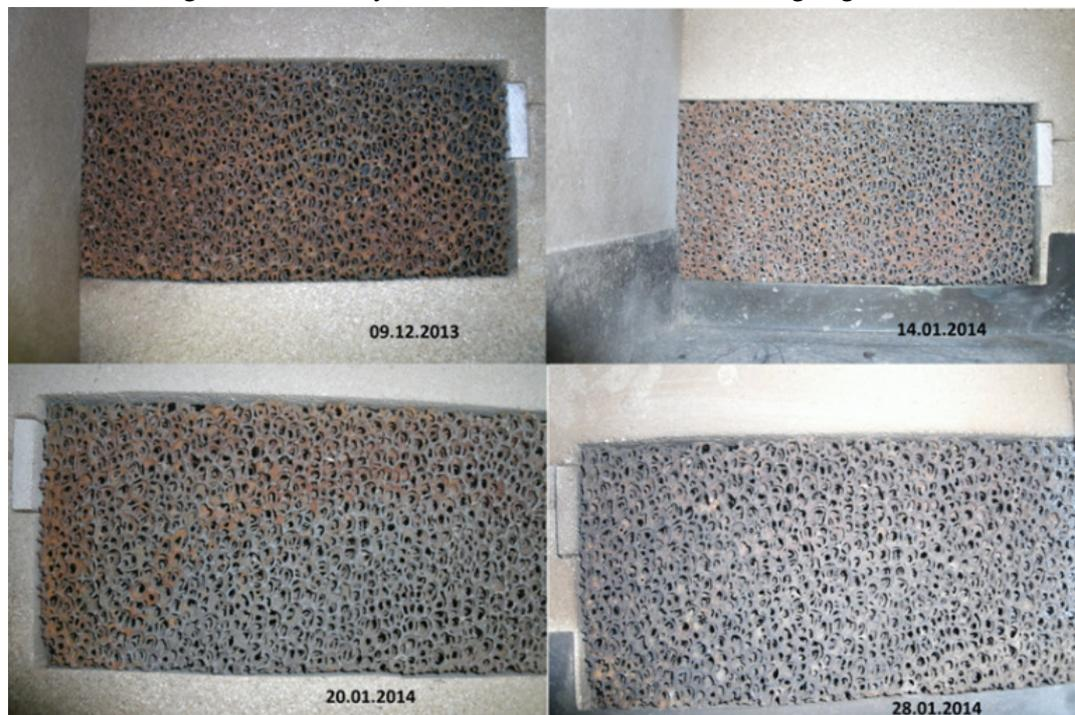
**Abbildung 39: Fotografien des Wandkatalysators ( $MnO_x/Al_2O_3$ -Schwamm) nach Einsatz im Kaminofen am Feldstandort über 75 Tage**
