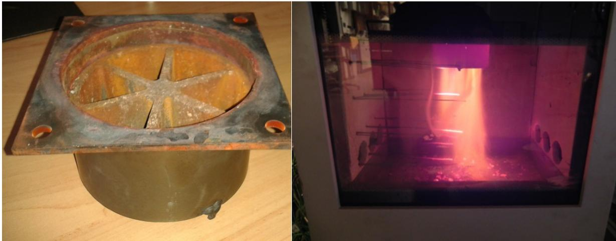
Abbildung 27: Fotografien des MnO<sub>x</sub>/SiC-Monoliths als Down-Stream-Rostkatalysator (links: nach Versuchsende, rechts: im Betrieb)
