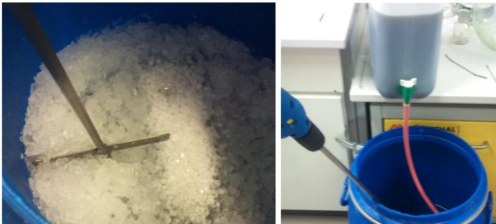
Abbildung 1: Herstellung der 20 L Natronlauge mit Eis aus destilliertem Wasser (li.) und Zugabe der Nickel- und Eisennitrat-Lösung zur Fällung der Metallhydroxide (re.)
