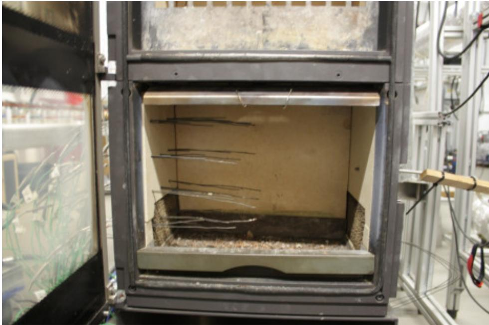
**Abbildung 25: Fotografie des Versuchsaufbaus mit katalytisch aktivierten Schwämmen (MnO<sub>x</sub>/Al<sub>2</sub>O<sub>3</sub>, Größe: 90 × 200 × 20 mm) im unteren Brennraum des xeos X8**
