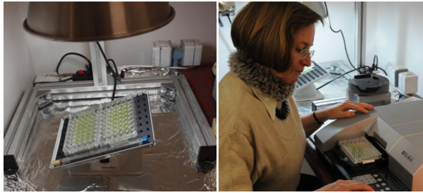
Abb. 3.3-1: Mikroplatten-Versuchsaufbau (links) und Mikroplattenreader (rechts).
