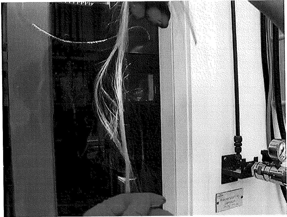
Bild 22: Am Fraunhofer ISC im Labormaßstab hergestellte chloridfreie Grünfasern mit Mowiol 18/88 als Spinnhilfsmittel. Die Grünfasern haben Längen > 20 cm und sind flexibel.
