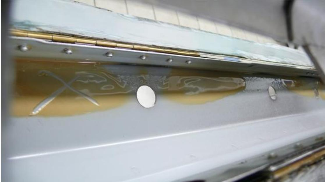
Abbildung 12: Verteilung in einem Originalschweller mit anschließender Gelierung
