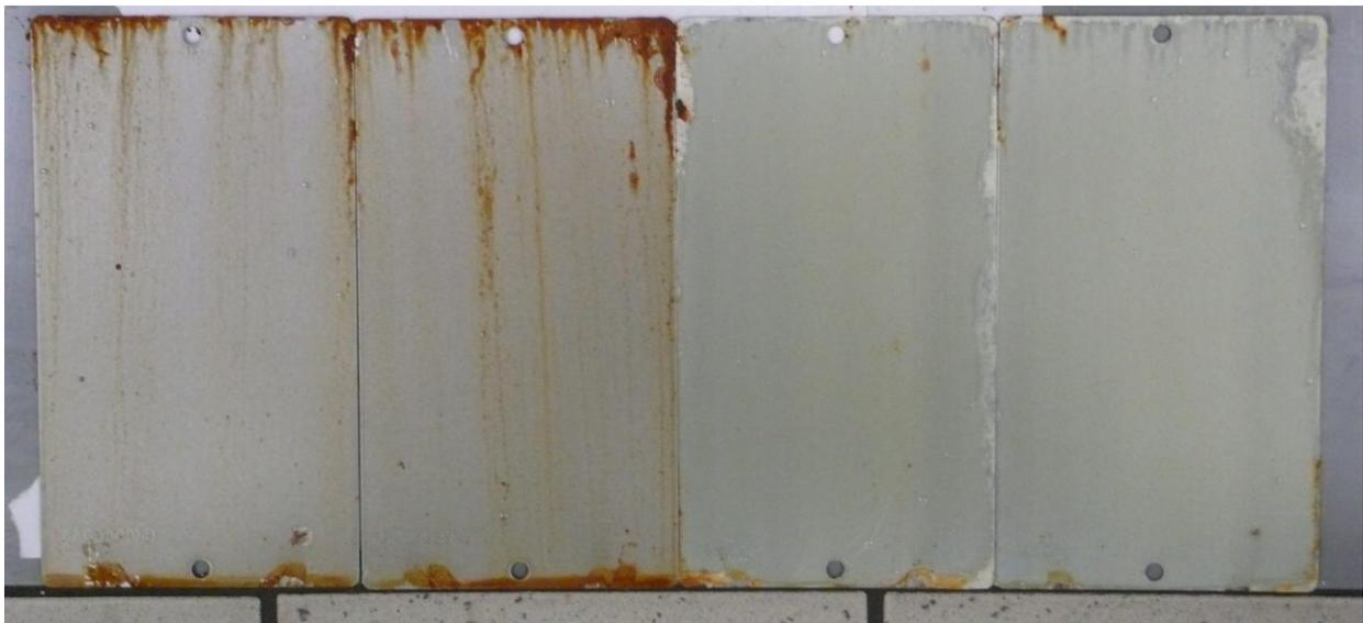
Abbildung 9: Testbleche nach 480 h Salzbelastung DIN EN ISO 9227
