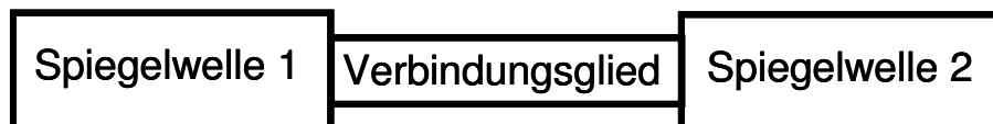
Abbildung 8: Verbindung zweier Wellen mittels Verbindungsele- ment, welches Zusatzfunktionen wie Lagerung übernehmen kann.
