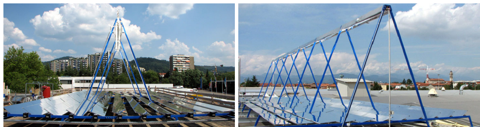
Abbildung 2: Prototypen des Prozesswärmekollektors, die im Rahmen des vergangenen DBU- Fördervorhabens (Az 23951) realisiert wurden
