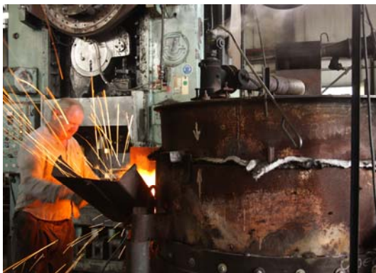
Abbildung 8/9: Derzeit im Unternehmen eingesetzte Schmiedeöfen ohne Wärmerückgewinnung.
