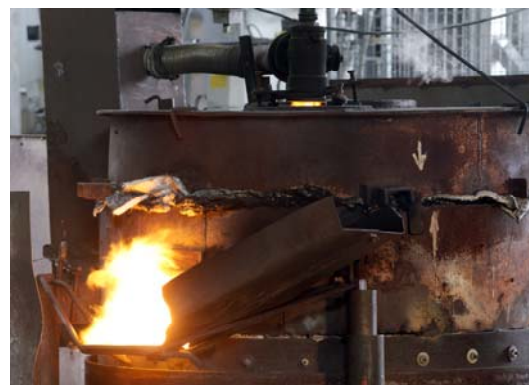
Abbildung 8/9: Derzeit im Unternehmen eingesetzte Schmiedeöfen ohne Wärmerückgewinnung.
