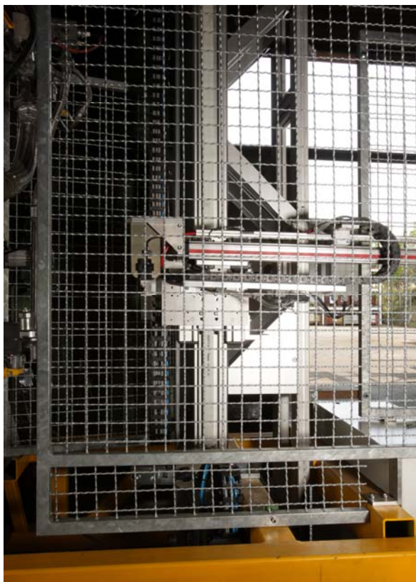
Abbildung 5: Transporteinrichtung der Schmiedeteilezuführung in den Rekuperator
