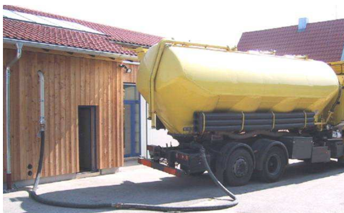
Bild 3.1: Lagerung von Pellets in einem Erdtank und Anlieferung durch Einblasen vom Lieferfahrzeug in ein Lager im Gebäude
