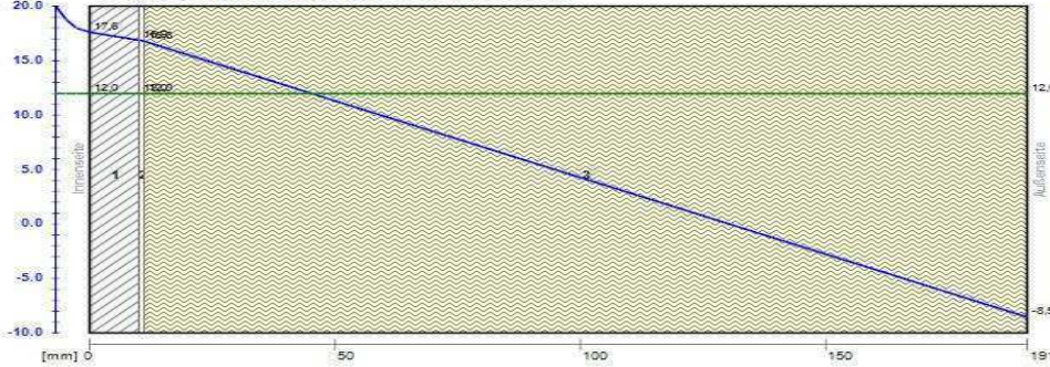
Temperaturverlauf im Schichtaufbau
