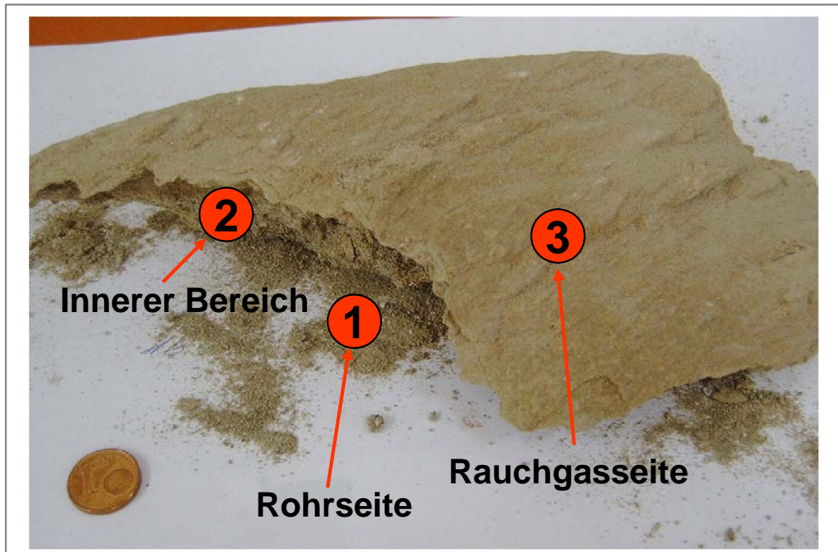
Abb. 54 Größere Wechten im Bereich des vorderen Rauchgaszuges (Verdampfer), obere Probenahmeebene: MHKW Mannheim, MK 5, 1. Probenahme
