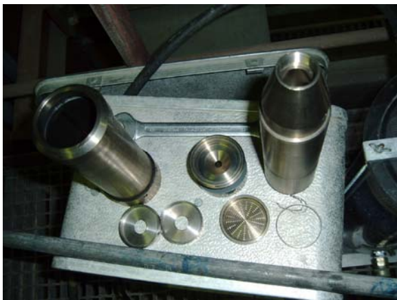
Impaktor-Sonde mit Träger für die Filter für die Korngrößenabhängige Beprobung
