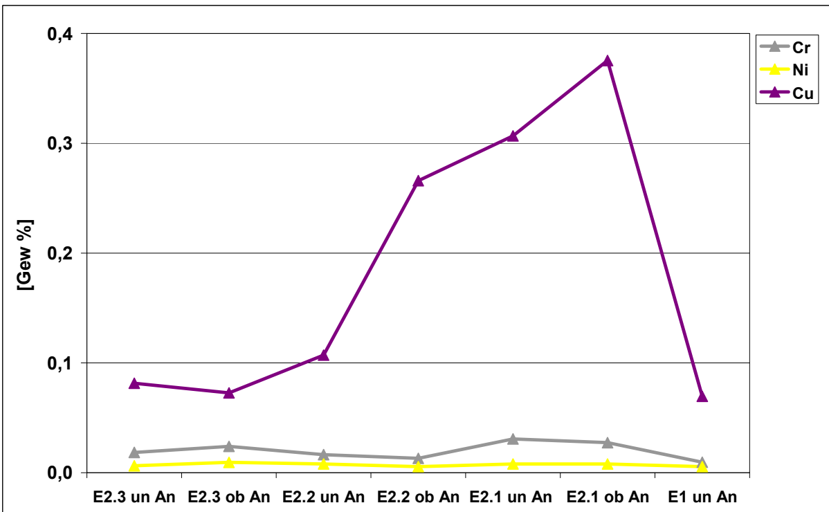
Abb. 50 Verteilung von Chrom, Nickel und Kupfer in den Beläge der Anströmseite: MHKW Mannheim, MK 4, 2. Probenahme
