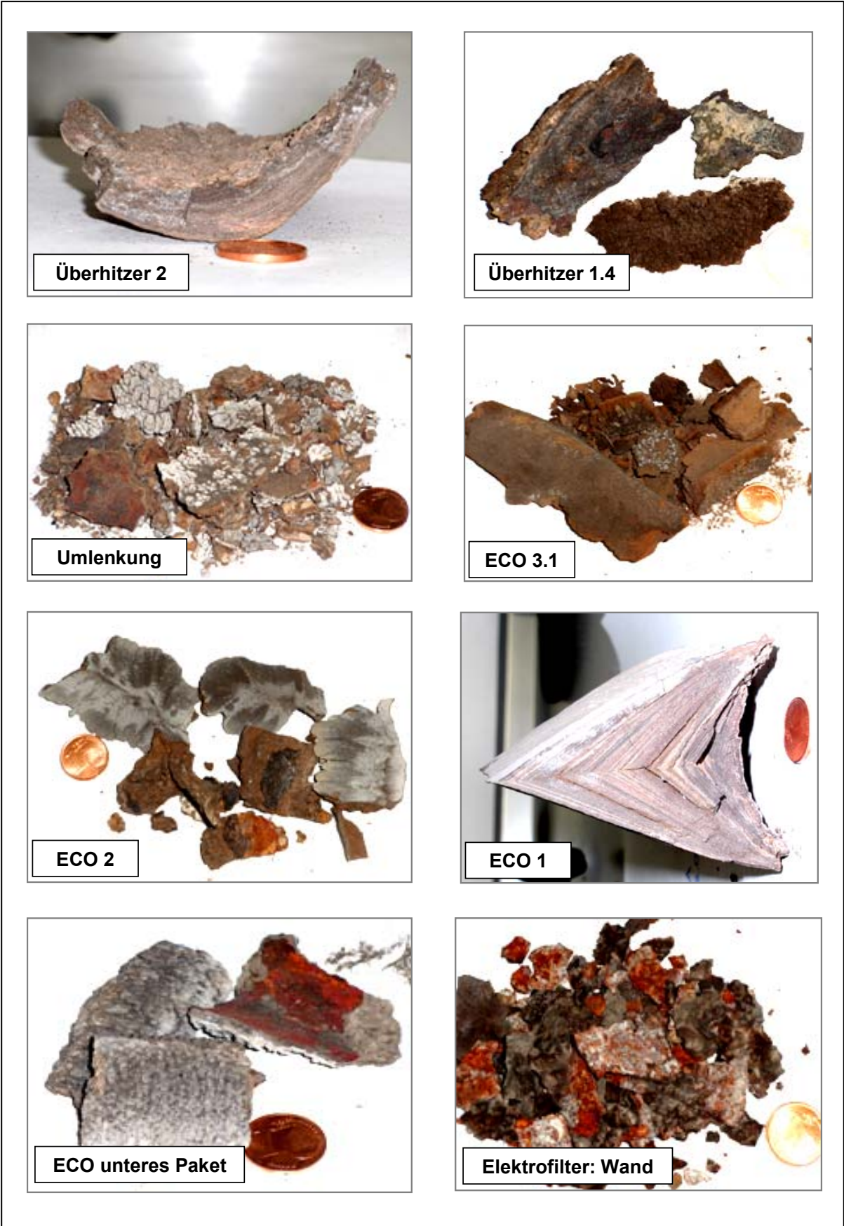
Abb. 137 Makroskopischer Aufbau der Beläge: Bio- und Holzkraftwerk
