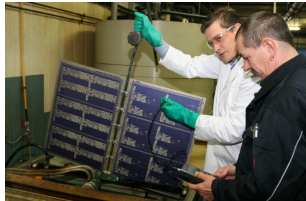
Foto 2: Die Leiterplatte ist mit Nickel beschichtet; hier erfolgt die Erfolgskontrolle mit einem Schichtdickenmeßgerät in Bohrungen
