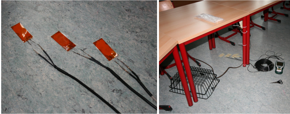
Abbildung 25: Aufbau der temporären Oberflächentemperaturmessung auf dem Fußboden im Klassenraum 0.3. Im linken Foto sind die drei Oberflächensensoren dargestellt, welche mit Wärmeleitpaste auf den Fußboden geklebt wurden. Im rechten Bild sind der Datenlogger sowie der Korb, der später zum Schutz über den drei Messpunkten positioniert wurde, zu sehen. Die Sensoren sind hier bereits mit Kreppband fixiert.
