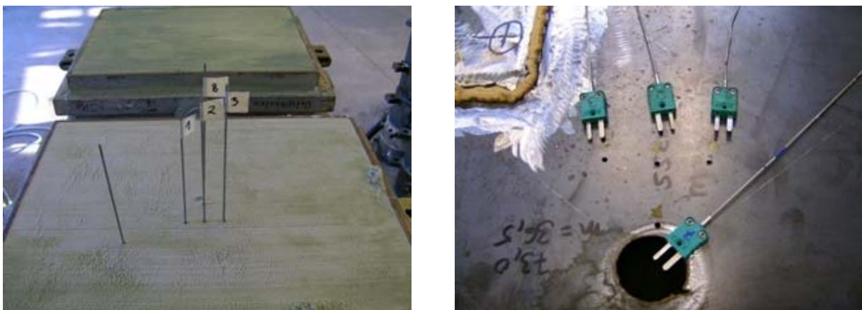
Abbildung 11: Position der Thermoelemente in der Form und an der Abdeckung
