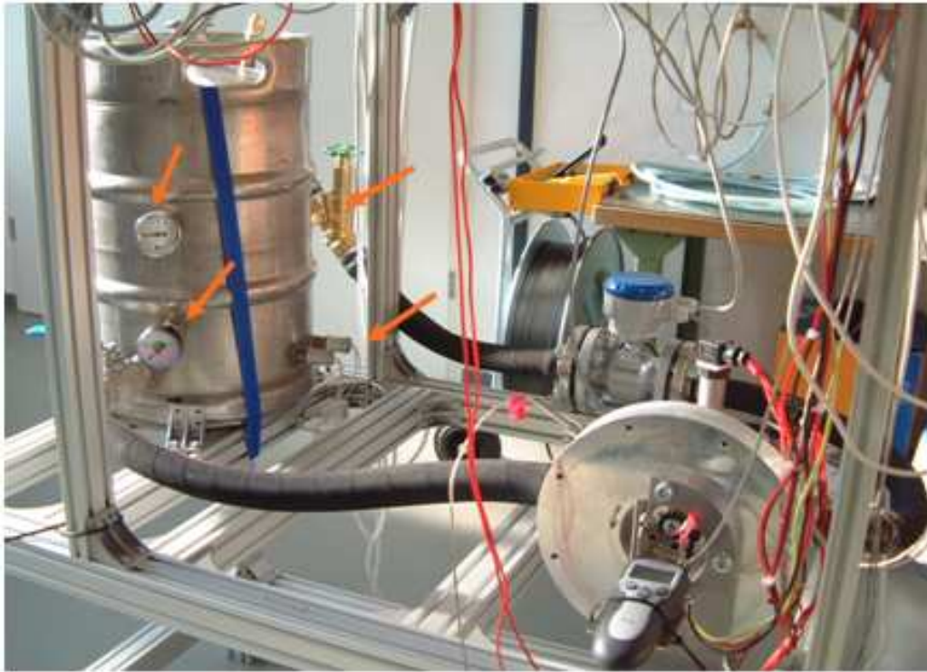
Abbildung 12: Prüfstand mit Manometer, Thermometer, Drosselstelle, Heizstäbe
