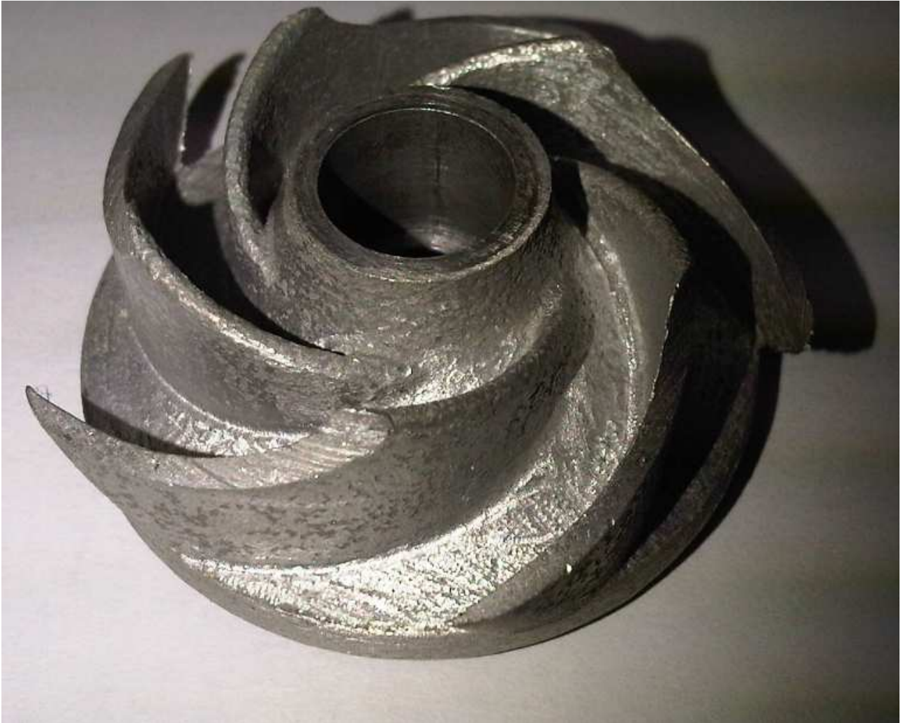
Abbildung 10: Pumpenrad, ursächlich für die Porosität der Oberfläche ist das verwendete Herstellverfahren, nicht eine eventuell auftretende Kavitation
