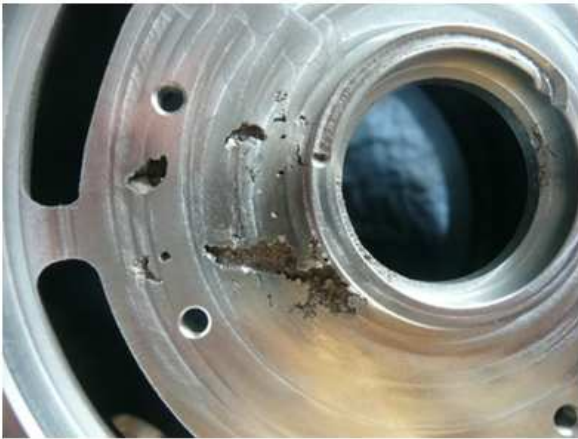
Abbildung 30: Lunker im Außengehäuse
