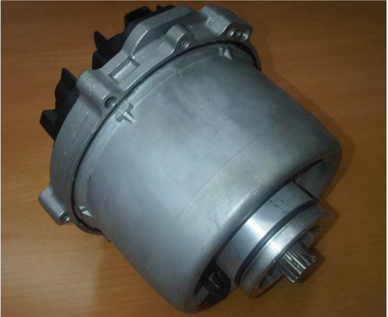
Abbildung 22: der Generator nach dem Umbau
