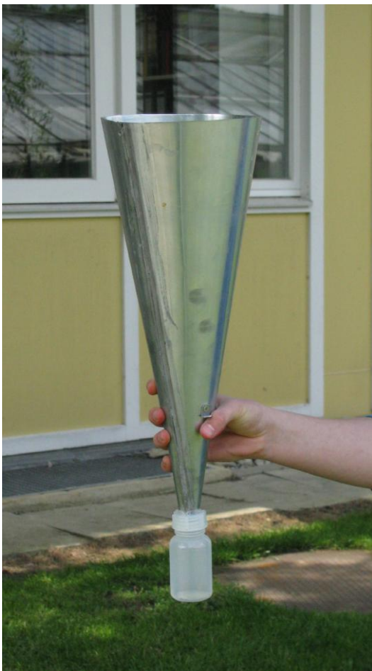
Abbildung 1.2: Einzeltrichter der modifizierten Berlese-Apparatur zur standardisierten Extraktion von Arthropoden aus frischen Hopfendolden, mit unten angeschraubter Fangflasche. Fotos: F. Weihrauch
