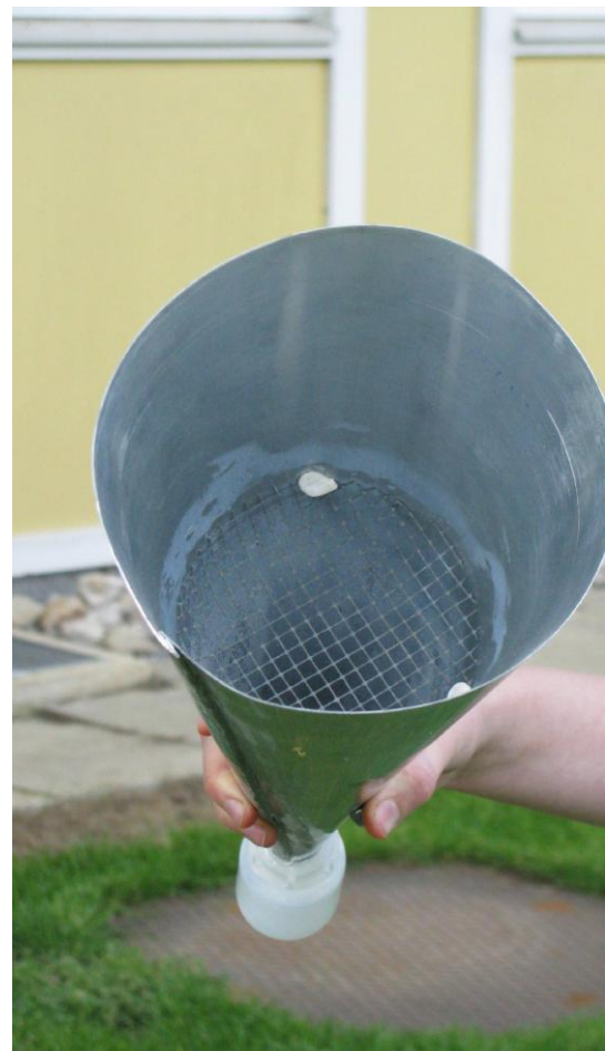
Abbildung 1.2: Einzeltrichter der modifizierten Berlese-Apparatur zur standardisierten Extraktion von Arthropoden aus frischen Hopfendolden, mit unten angeschraubter Fangflasche. Fotos: F. Weihrauch
