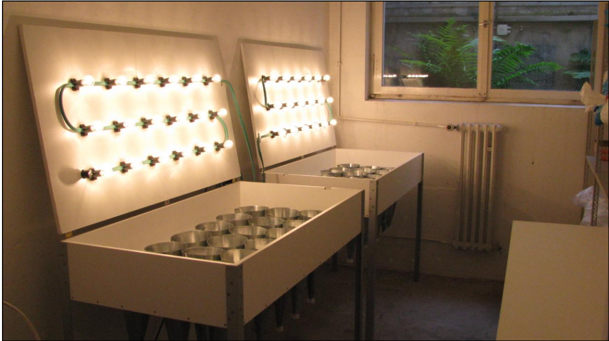
Abbildung 1.1: Überblick über die modifizierte Berlese-Apparatur zur standardisierten Extraktion von Arthropoden aus frischen Hopfendolden. Foto: F. Weihrauch
