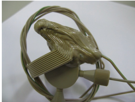
Abbildung 58: Geschmolzene PEEK-Teile nach Bestrahlung in der Mikrowelle „Discover“ von CEM
