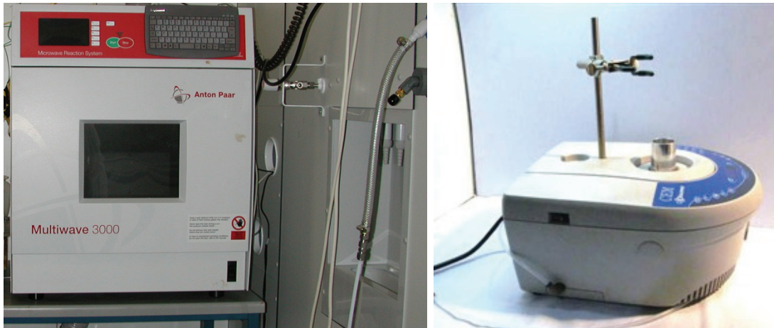
Abbildung 44: Links: Multimode-Mikrowellengerät „Multiwave 3000“ von Fa. Anton Paar Rechts: Single-mode Mikrowellengerät „Discover“ von CEM
