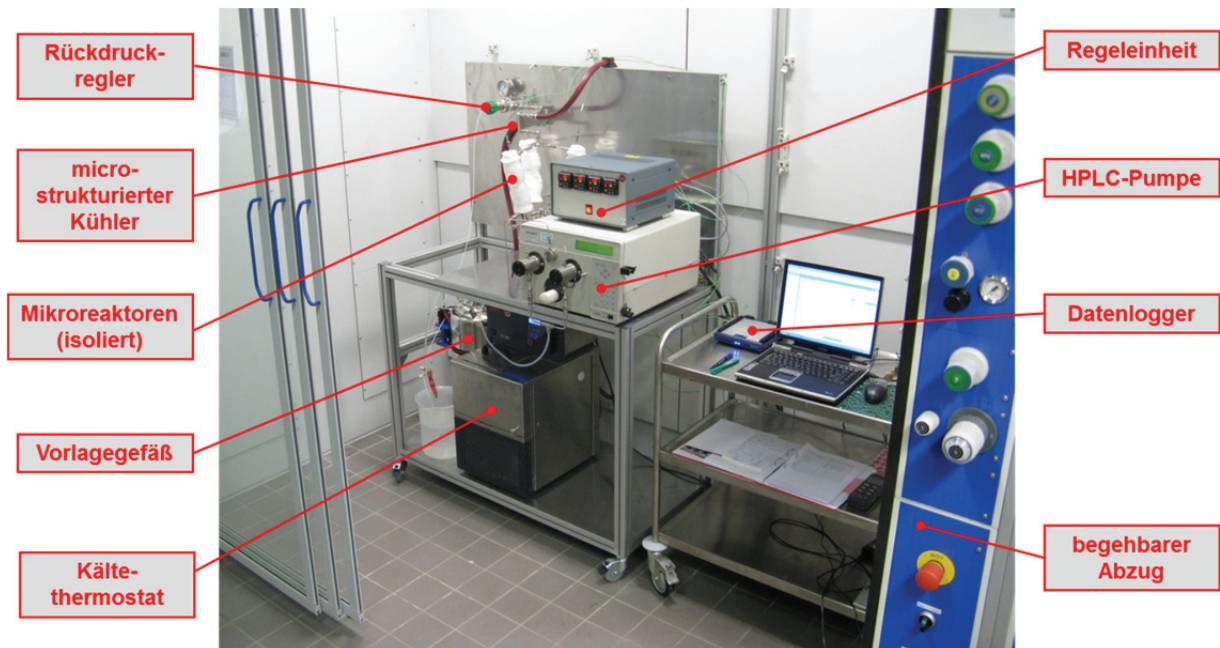
Abbildung 61: Pilotanlage mit 3 parallel betriebenen Mikroreaktoren (Status vor Isolierung)
