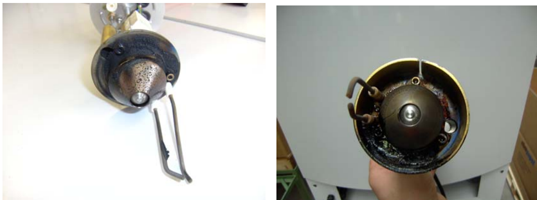
Abbildung 29: Langzeitversuch Prototyp IV, Mischeinrichtung
