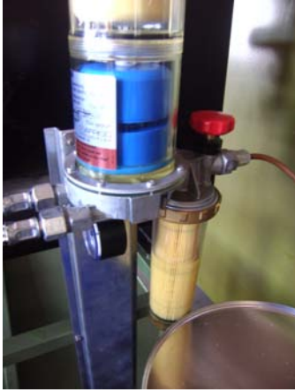
Abbildung 44: Filter mit automatischer Entlüftung
