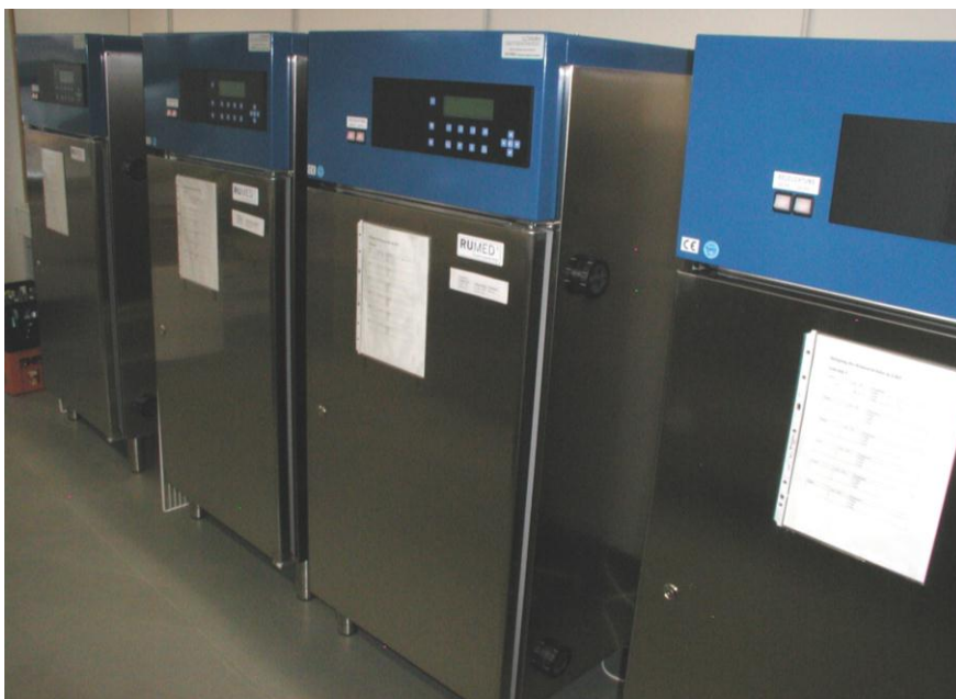
Abb. 10: Klimaschränke der Professur für Landschaftsökologie an der Universität Gießen. Hier werden die Keimungsversuche mit Herbstzeitlosesamen unter kontrollierten Licht- und Temperaturbedingungen durchgeführt.
