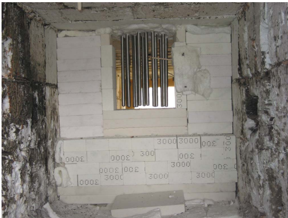
Abbildung 44: Foto des angepassten Brennkammerinnenraumes mit Modul
