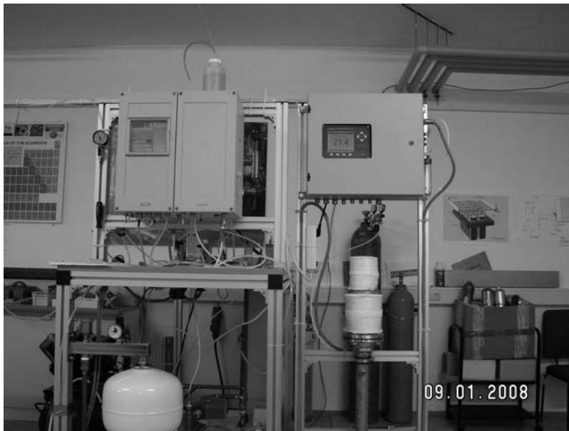
Abbildung 9: Erfassung der Sauerstoffkonzentration unterschiedlicher Gasströme (Permeat, Retentat, Bypass) mit Oxymat (links) und ZrO 2 -Sonde (rechts).
