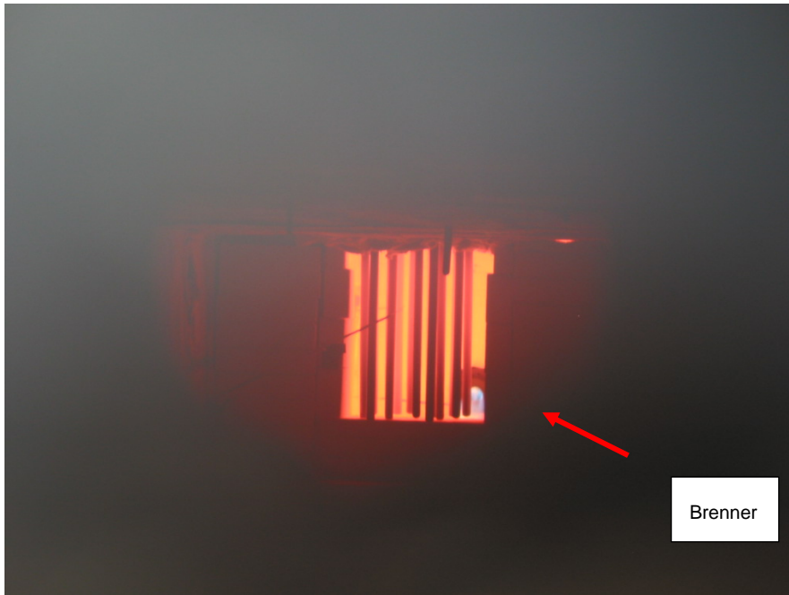
Abbildung 50: Blick vom Kaminende der BFI- Feuerungsanlage auf das Modul, Prozesstemperatur zwischen Brenner und Modul: ca. 900 °C
