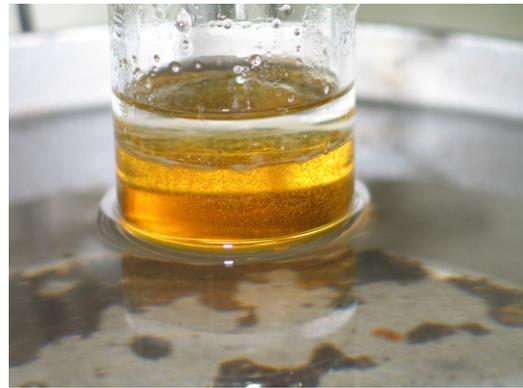
Abbildung 12 wurde ca. 20 Minuten nach Zugabe des HMDS' aufgenommen. Am Rand der Phasengrenze ist ein farbloser Niederschlag zu erkennen. Dieser Niederschlag breitete sich danach in kurzer Zeit über die gesamte Phasenoberfläche aus. Danach begann sich die obere Phase einzutrüben, wie in Abbildung 13 zu sehen. Diese Aufnahme wurde ca. 85 Minuten nach Start der Reaktion aufgenommen.
