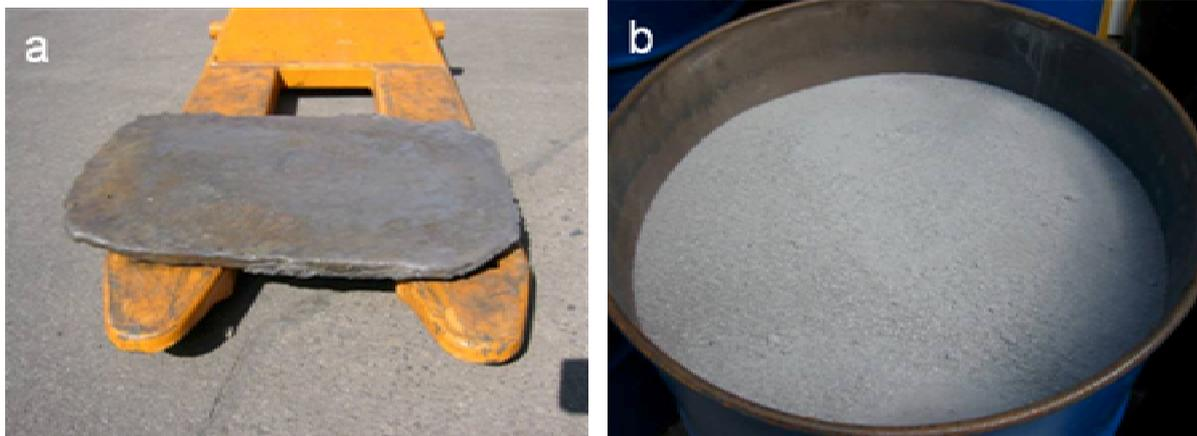
Abbildung 34: a: FeMn-Ingot und b: Flugstaub (hoher ZnO-Inhalt) aus den Schmelzversuchen zum Recycling von pyrolysierten Primärbatterien
