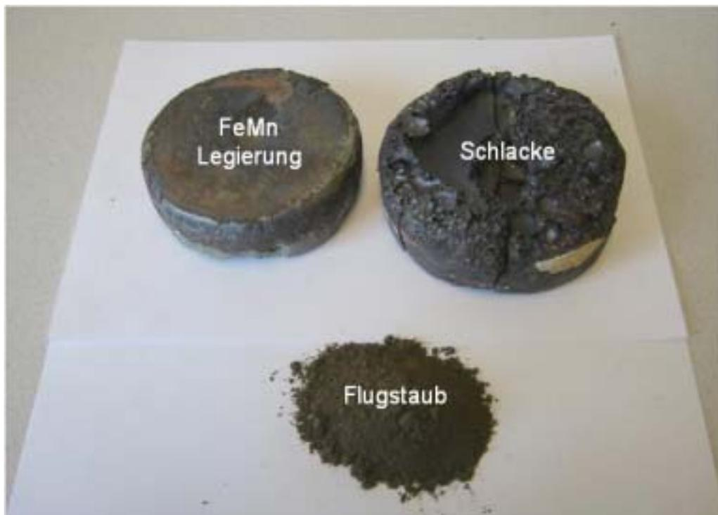
Abbildung 31: Produkte der LBO-Labormaßstabversuchen: FeMn Legierung, Flugstaub und Schlacke
