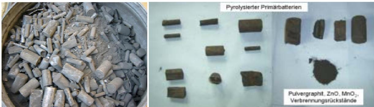
Abbildung 7: Pyrolysierte Batterien (links) und ihre Komponenten (rechts)
