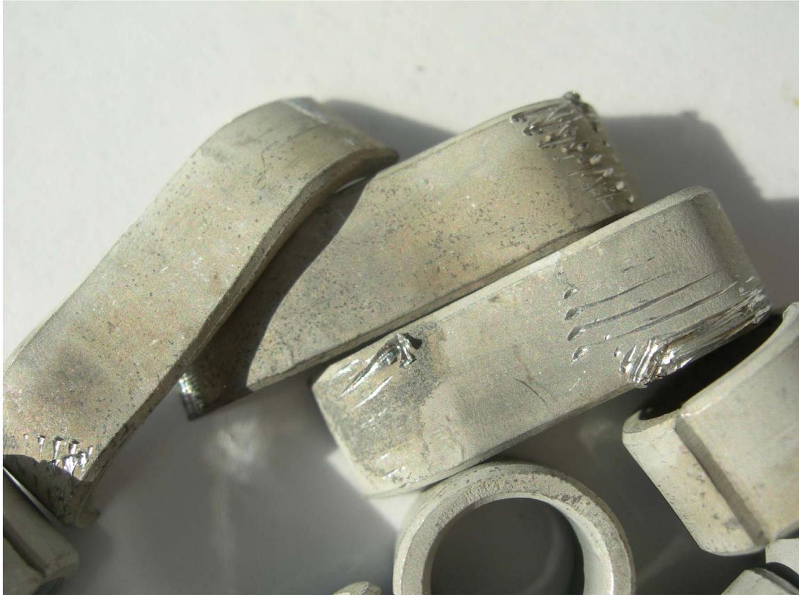
Abb. 11: Aufgebogene Ringstücke, keine Abplatzer
