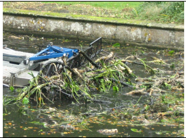
Rechenaufsatz am Schwimmbagger, hier nach einem Griff in den Gräftengrund beim Ausheben der dabei erwischten Rhizome
