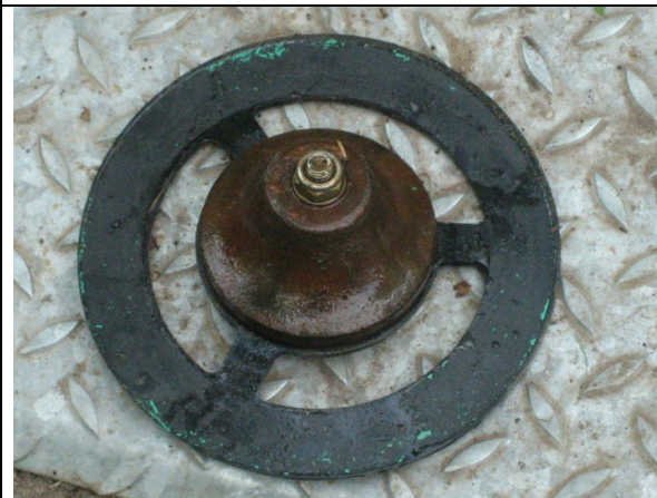
Hubdichtung zwar mit korrektem Gewicht, jedoch mit Öffnungen zwischen drei Stegen und als Dichtungsmaterial Kunstkautschuk
