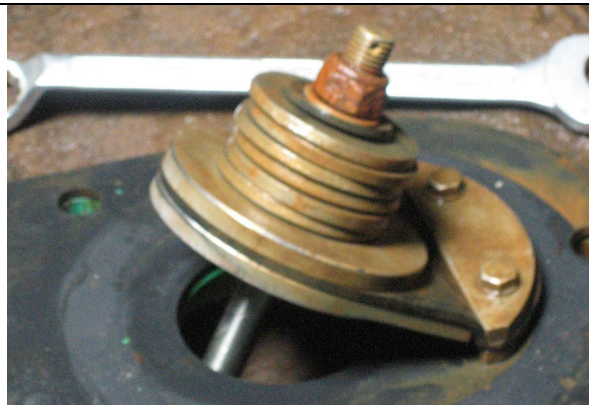
Stoßventil, das bei hoher Durchflussgeschwindigkeit zuklappt und durch die Druckentlastung über den Windkessel wieder aufgerissen wird
