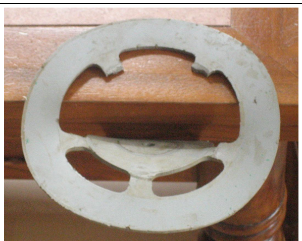
Mehrfach gerissene Dichtung aus Naturkautschuk, der neben der Fehlkonstruktion (auch bei fünf Stegen) sich als Material überhaupt nicht eignet
