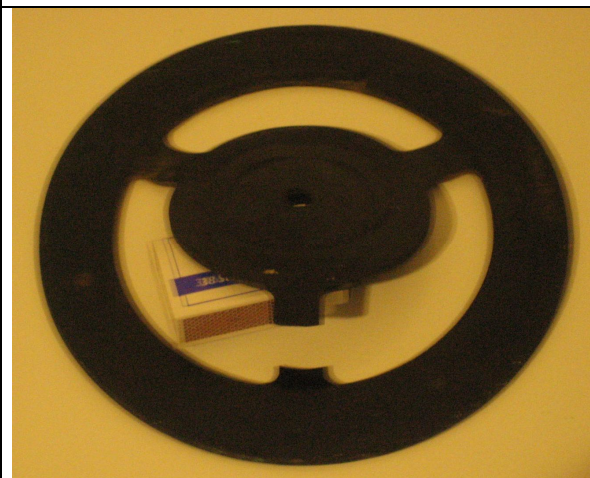
Gerissene Hubdichtung aus Naturkautschuk bei der Fehlkonstruktion über drei Stege
