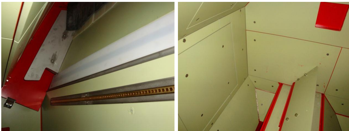
Abbildung 7: Röntgensensorabdeckung, Düsenleiste und Auslassschächte
