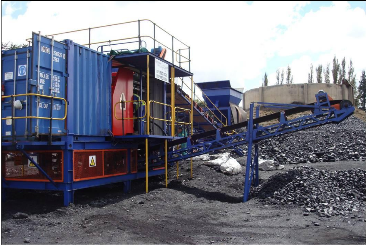
Abbildung 10: Pilotanlage mit Röntgensortierer (rot), ARNOT Mine & Power Station, RSA
