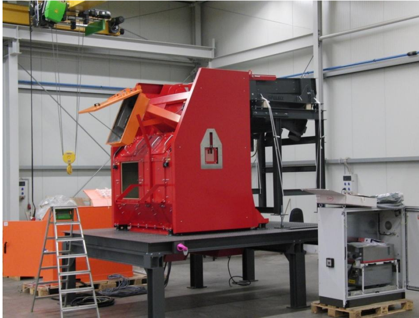
Abbildung 8: Sortierer im Technikum Wedel mit Vibrationsrinne
