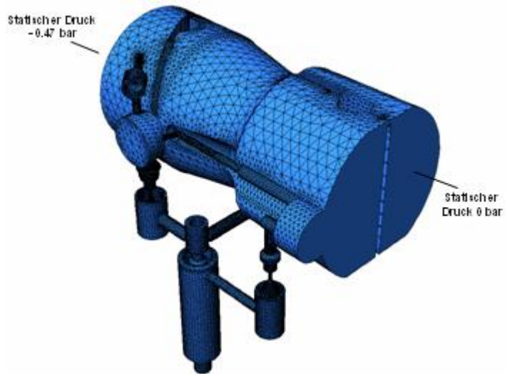
Abbildung 18: Vernetztes Volumenmodell für die Luftströmung im EFC-Vergaser. Filigrane Stellen, wie z.B. die Drosselklappe, wurden feiner aufgelöst.
