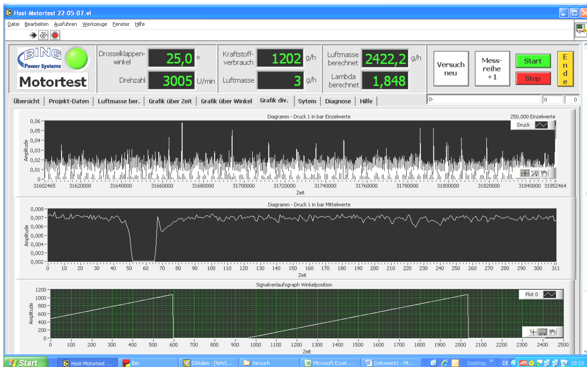
Abbildung 11: Druckverlauf der Kraftstoffzuleitung im Vergaser
