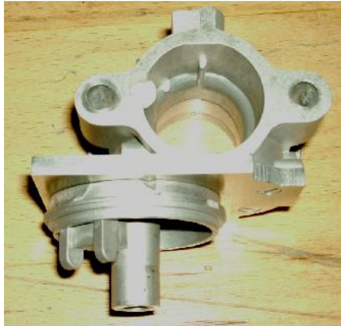
Abbildung 9: Vergasergehäuse als gefrästes Muster mit Seitenschwimmer
