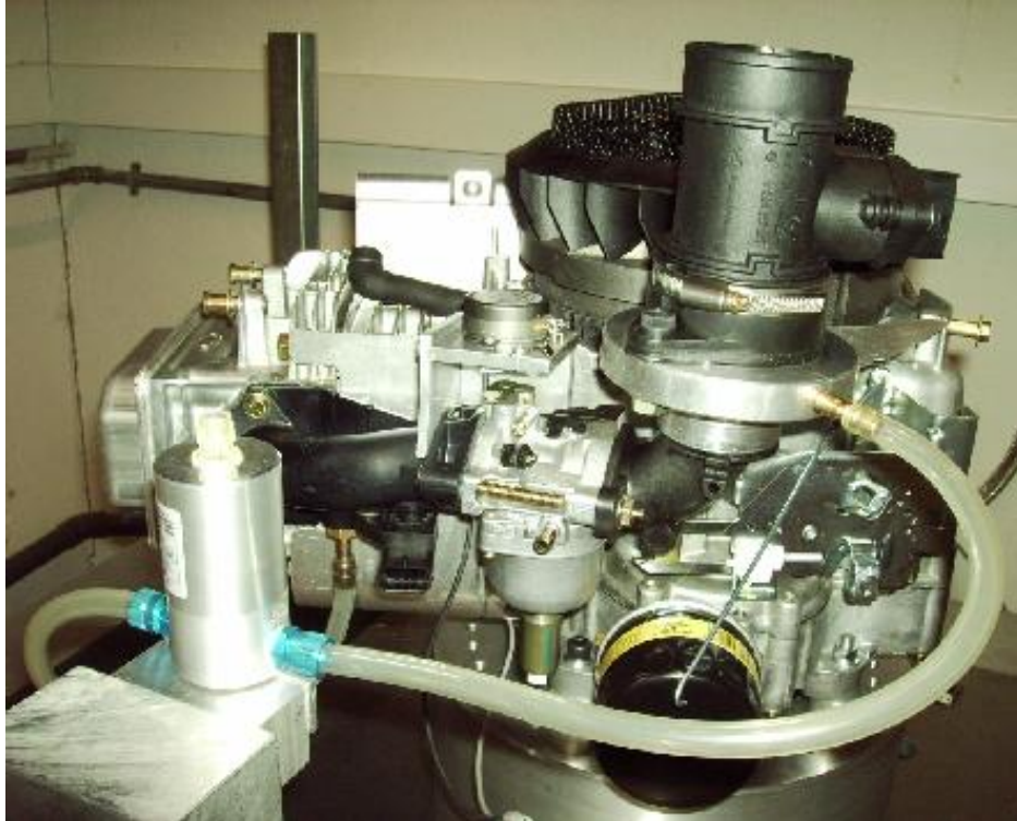
Abbildung 2: Motorenprüfstand der BING GmbH mit Rasenmähermotor für Grundversuche und Vergaserabstimmung
