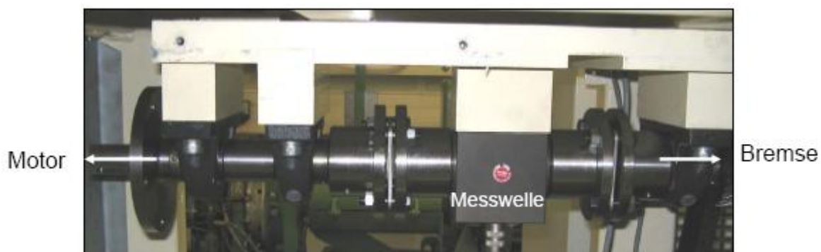
Abbildung 36: Drehmomentenwelle am Prüfstand
