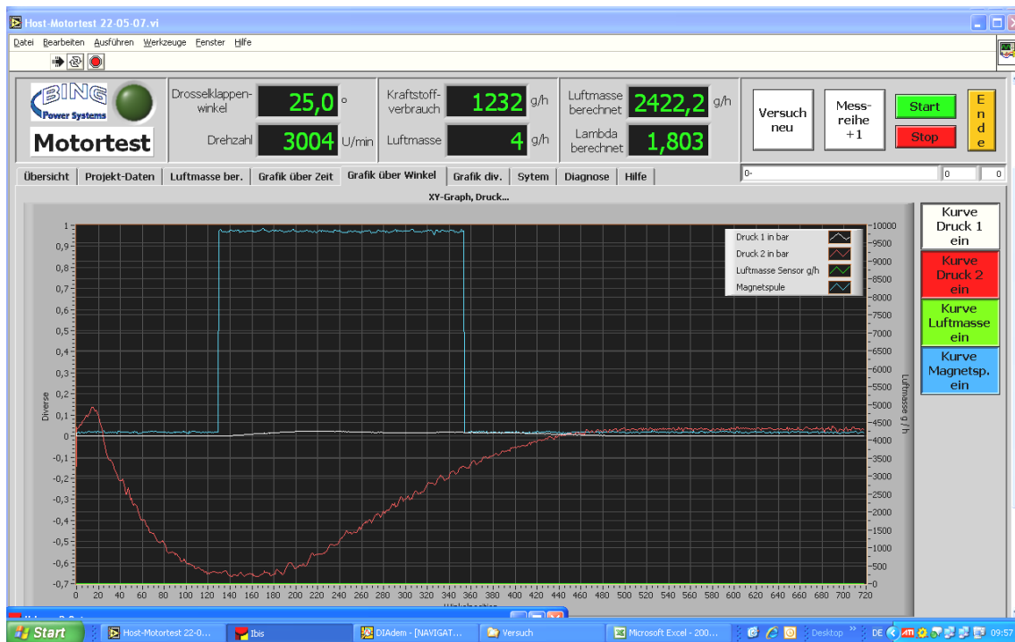
Abbildung 10: Saugrohrunterdruck und Ein-Ausschaltzeitpunkt des Magnetventils
