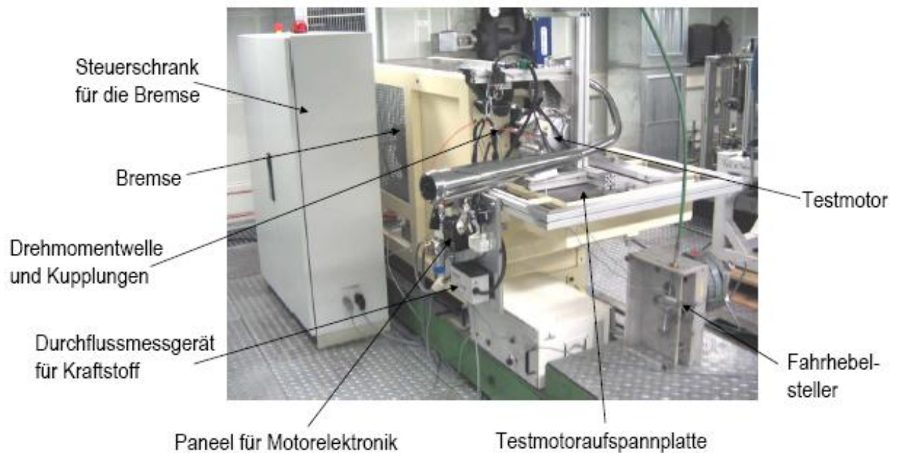
Abbildung 33: Komplett aufgebauter Prüfstand mit 125 ccm Motor
