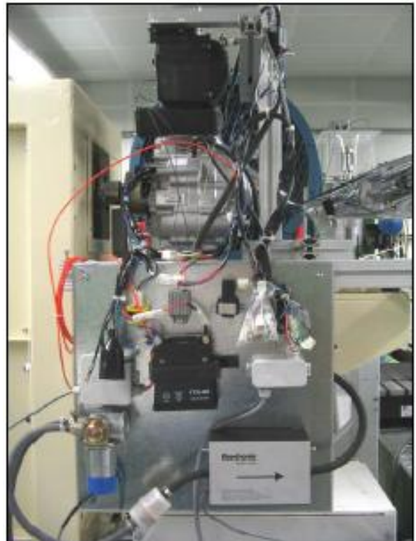
Abbildung 32: Anschließen des Kabelbaumes und des Fahrthebelstellers
