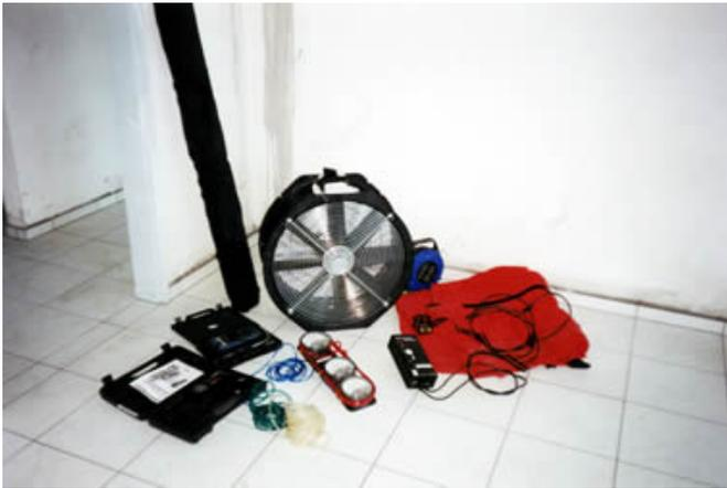
Abbildung 4.5: Komponenten des Blower-Door-Systems
