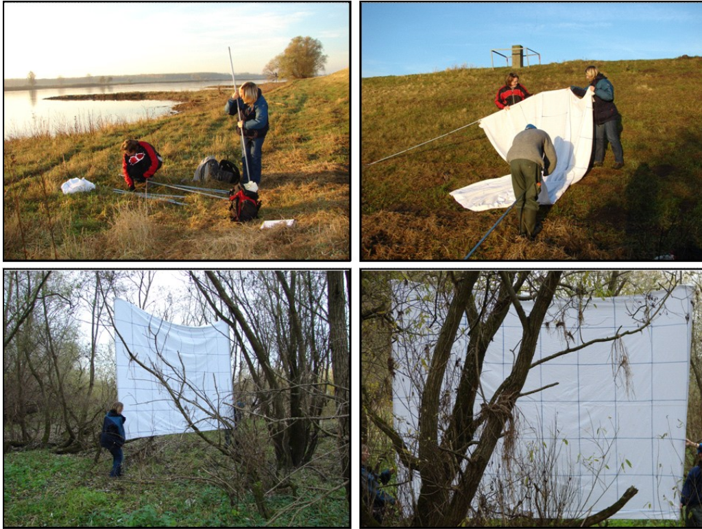
Abbildung A-16: Aufbau des Messrahmens: Verschrauben des Messrahmens (links oben), Aufziehen des Rasters (rechts oben), Transport des Rahmens im Gelände (links unten), Aufstellen des Rahmens hinter der Vegetation (rechts unten) (aus SCHNEIDER 2010).
