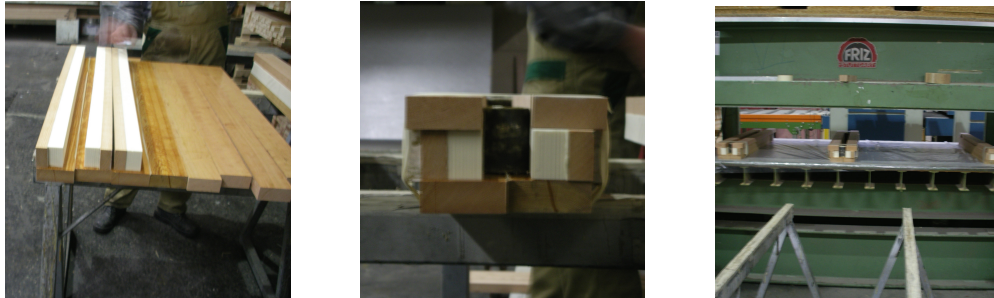
Abbildung 49: Verklebung von Lamellen und Isolierung zu Kanteln mit PUR-Kern
