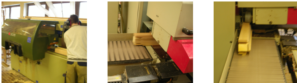
Abbildung 50: Fräsen und Profilieren der Kanteln
