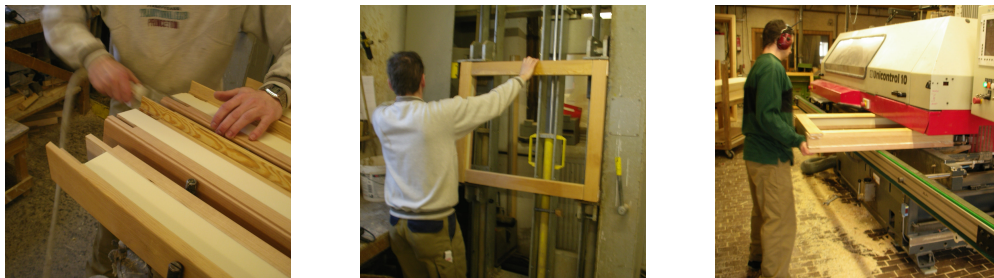
Abbildung 51: Die Kanteln werden zu Flügel oder Rahmen zusammen geklebt und geschliffen.
