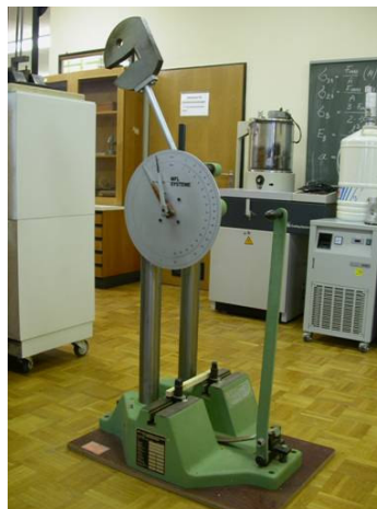
Abbildung 8: Für die Prüfung vorbereitetes Pendelschlagwerk
