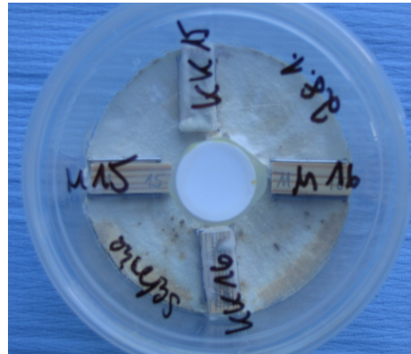
Abbildung 77: eingebaute Prüfkörper auf Prüfpilz; jeweils 2 behandelte und 2 unbehandelte Kontrollen in einem Prüfgefäß
