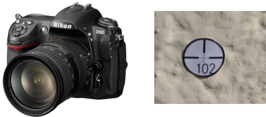
Abbildung 13: Aufnahmekamera, verwendete Zielmarken am Aufmaßobjekt
