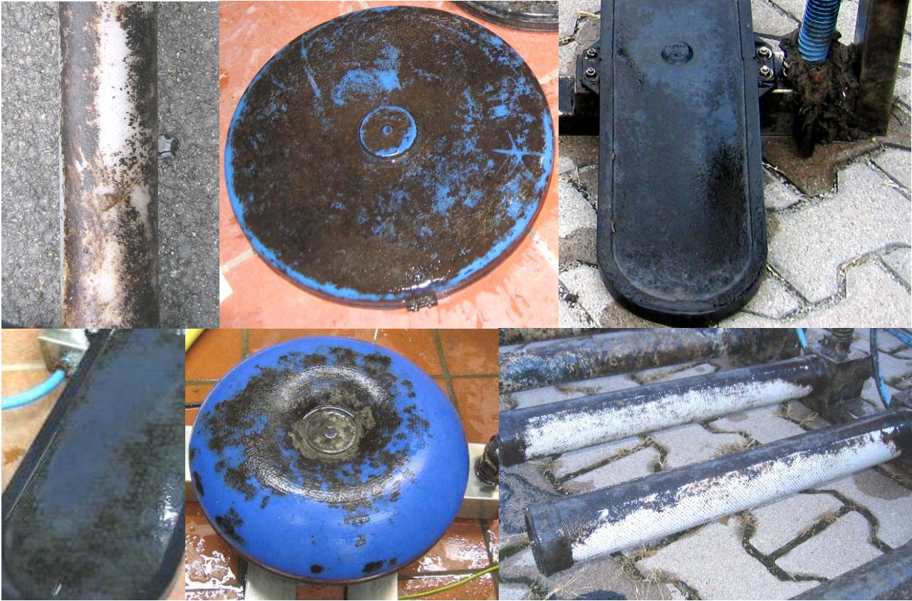
Abbildung 64: Beläge auf Silikon-Belüftungsmembranen
