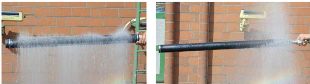
Abbildung 15: Abgasungsverhalten eines neuen und eines belegten Belüftungselementes
