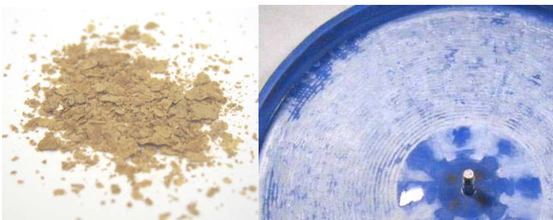
Abbildung 69: Trockenrückstand des filtrierten gereinigten Abwassers, Ablagerung im Tellerbelüfter
