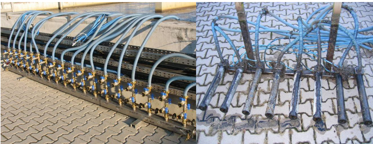
Abbildung 17: Versuchsstand C und dort eingebaute Rohrbelüfter
