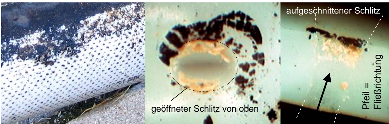
Abbildung 68: Biofilm auf der Belüftungsmembran und Beläge in den Belüftungsschlitzes - Silikon
