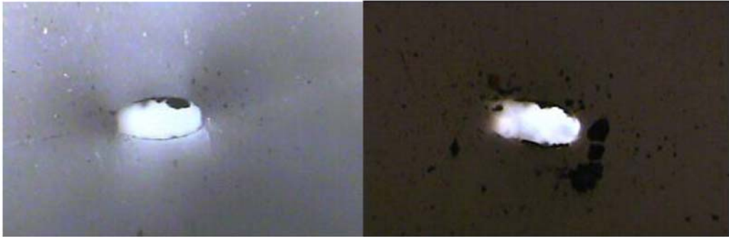
Abbildung 6 Belüftungsschlitze der Silikonmembran des Belüfters B nach der Hochdruckreinigung
