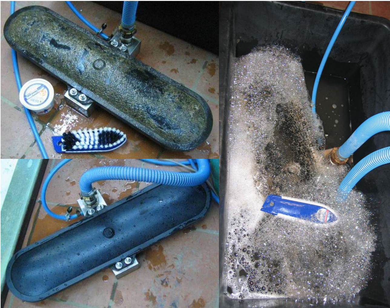
Abbildung 22: Plattenbelüfter vor, während und nach der Reinigung mit der Handbürste
