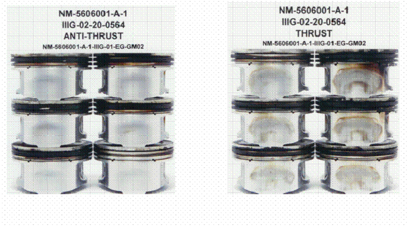
Bild 8: Ergebnis nach der Durchführung von Sequence IIIG: Bestimmung der oxidativen Stabilität, der Kolbensauberkeit, des Verschleißes und des Viskositätsanstieges (Dritter Lauf)
