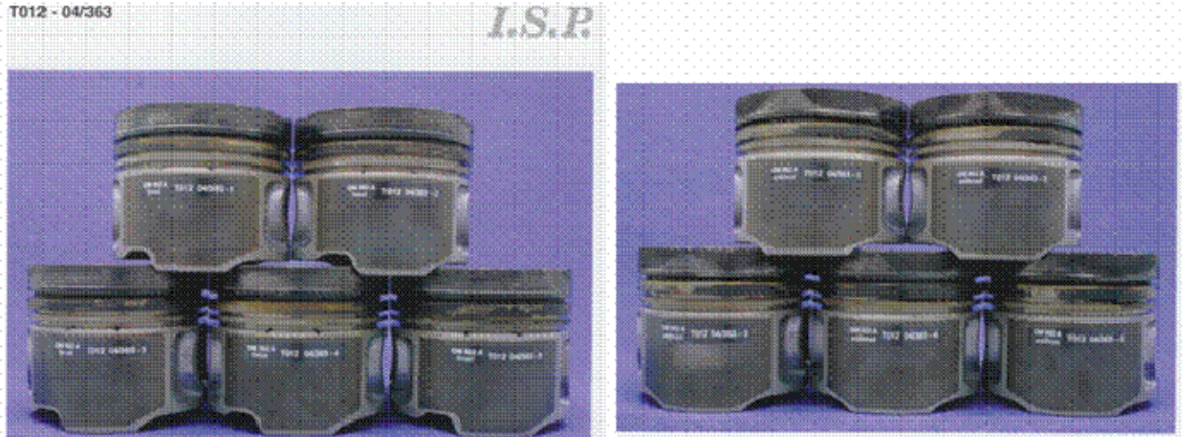
Bild 6: Ergebnis des OM 602A gemäß CEC L-51-T-98 : Bestimmung des Nockenwellenverschleißes, Kolbensauberkeit, Bore Polishing.
