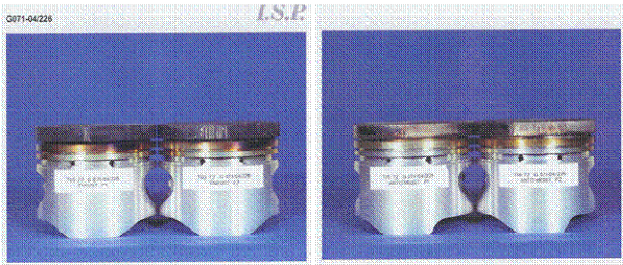
Bild 4: Ergebnis des Peugeot TU5JP gemäß CEC L-88-02
