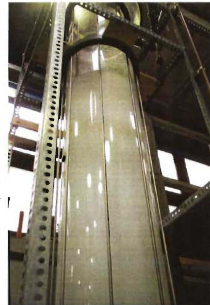
Bild 2.9: Kleine Versuchssäule während Gaslöseversuch
