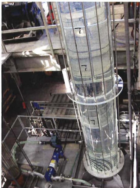
Bild 2.2: Foto der Versuchsanlage während eines Klarwasserversuches
