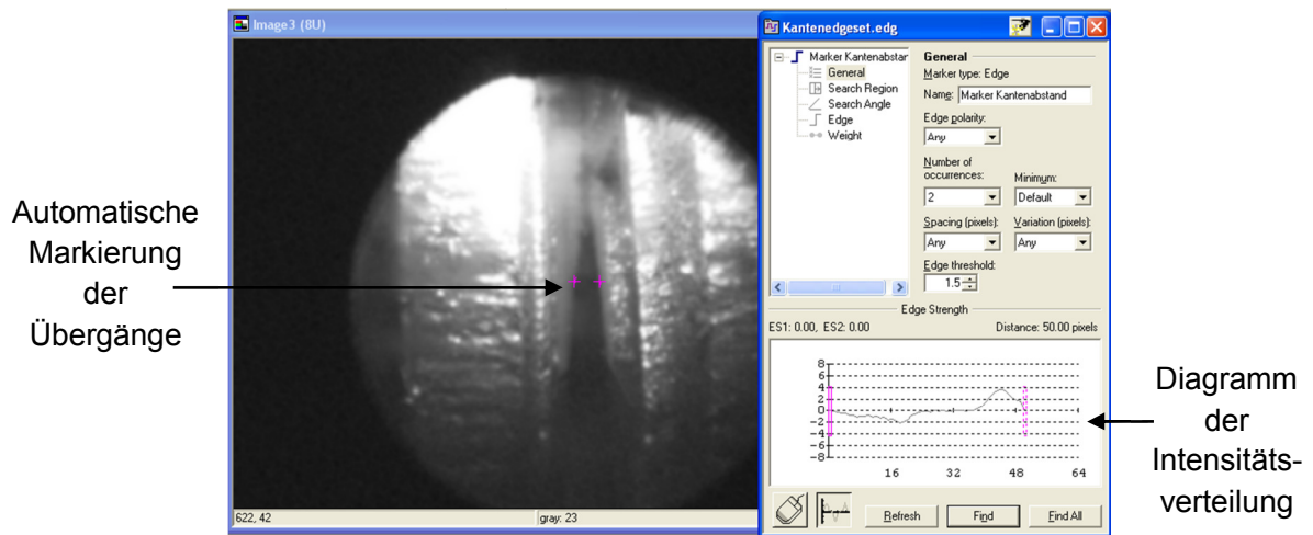
Abb. 36: Automatische Vermessung der Anlagerungszonen mittels der Software „Matrox Inspector®“
