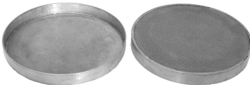
Abbildung 21: Probensiebe für den Batchtrockner zur Trocknung von feuchter Algenbiomasse (Restfeuchte ca. 80–90 %). Porenweite Innenseite: 4 µm. Verstärkungsdrahtgeflecht auf Unterseite
