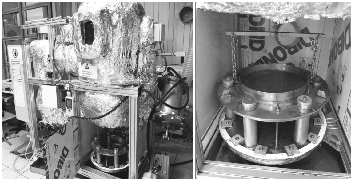
Abbildung 20: Der Konvektionsbatchtrockner von schräg rechts vorne (linke Abb.) und des Beschickungsgestells mit ungefülltem, eingesetztem Sieb (rechte Abb.)
