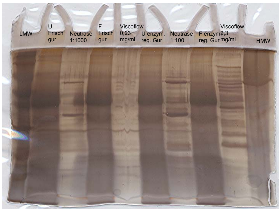
Abb. 45: SDS-PAGE von Unfiltrat und Filtraten aus dem gleichen Tank. Färbung: Silber-Nitrat. Die Filtrate stammen aus Filtration über Frischgur und über enzymatisch regenerierte Gur. Zum Vergleich sind die zur Regeneration eingesetzten Enzympräparate aufgetragen. Je 10 mg der gefriergetrockneten Biere wurden in je 100 \mu\text{L} \text{H}_2\text{O}_{\text{dest.}} gelöst (5-fache Konzentration). F: Filtrat, U: Unfiltrat
