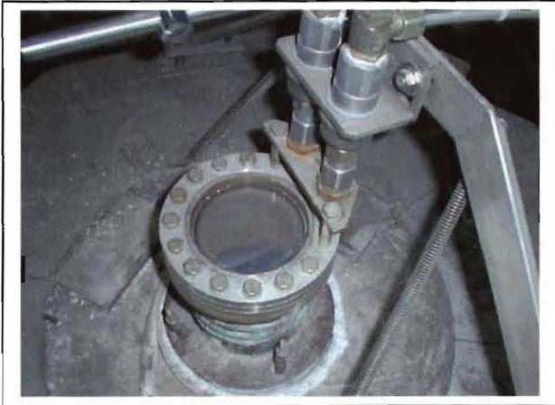
Abb. 10: Schauglas am Reaktorkopf.
