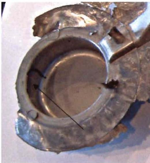
Abb. 7: Oberflächenveränderung an unbeschichteten Stellen.
