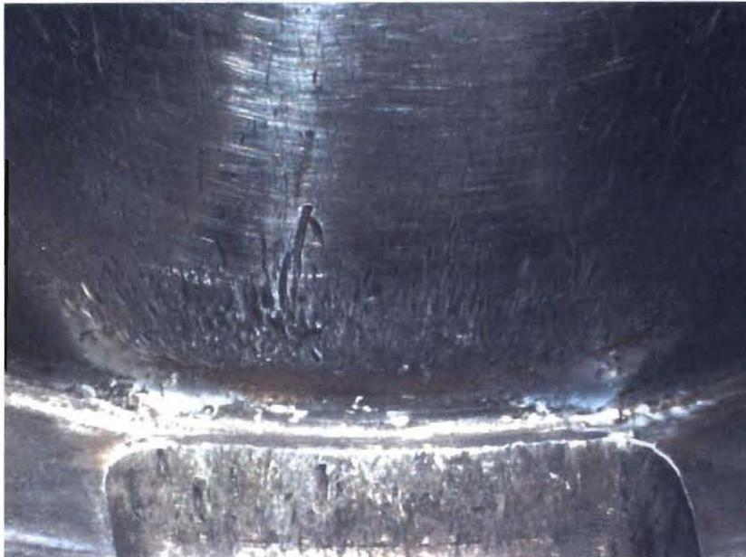
Abb. 6: Verschleiß des Grundwerkstoffes im Einspritzbereich.
