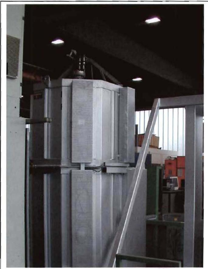
Abb.9 : Haubenofen und Aufnahmegerüst für den Reaktor der PACVD-Anlage.
