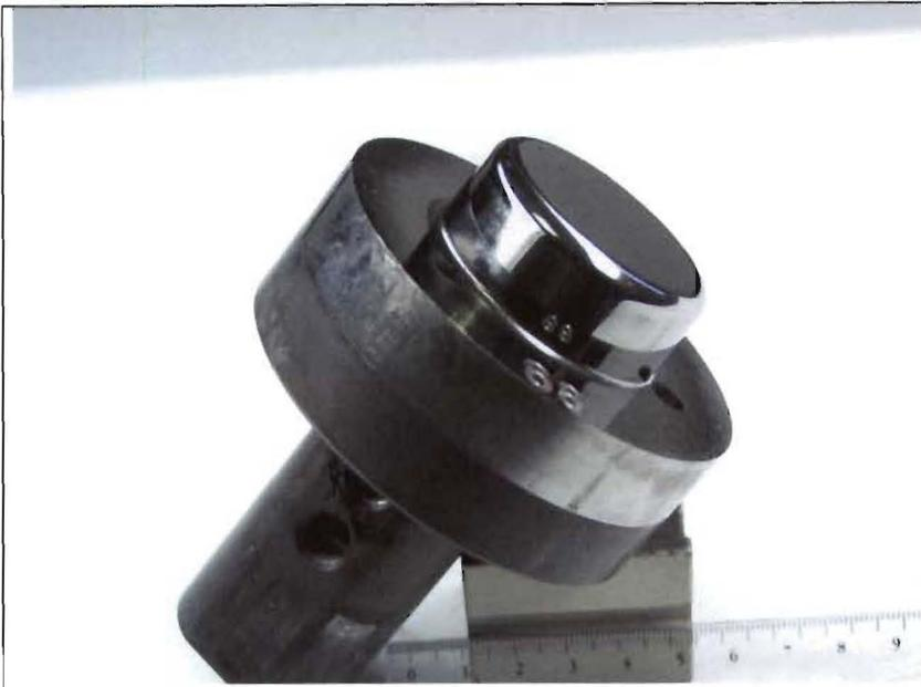
Übersichtsaufnahme nach dem Entfernen des Aluminium-Aufbaus. Beschichtung fast vollständig erhalten
