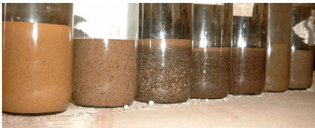
Abb. 5 Der Absetzversuch zeigt die Kornverteilung natürlicher Sande
