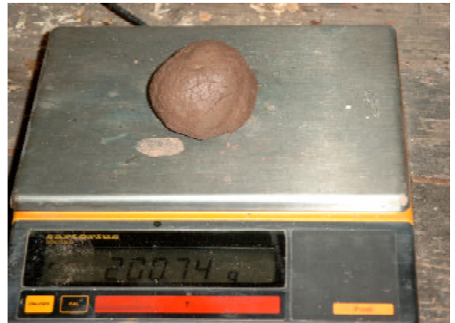
Abb. 4 200 g Lehm werden zu einer Kugel geformt.
