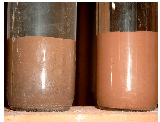
Abb. 11 ...nach einem Tag wird im Absetzversuch die Kornverteilung sichtbar
