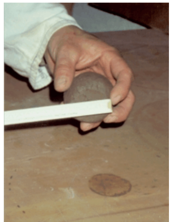
Abb. 5 Normsteifer Lehm nach der Kugelfallprobe
