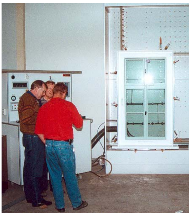
Abbildung 17 Kastenfenster im Prüfstand der Firma Juchheim in Fulda
