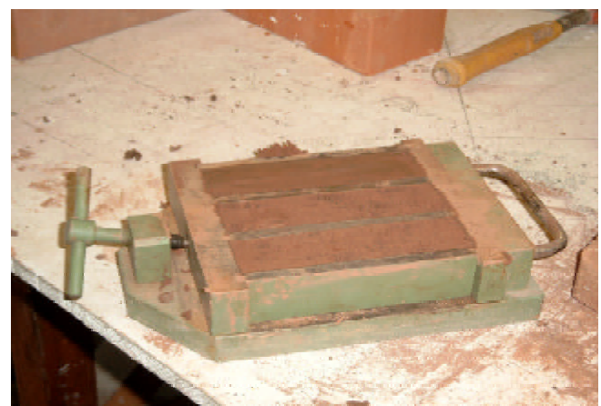
Abb. 8 Form zur Erstellung der Probekörper für die Schwindprüfung
