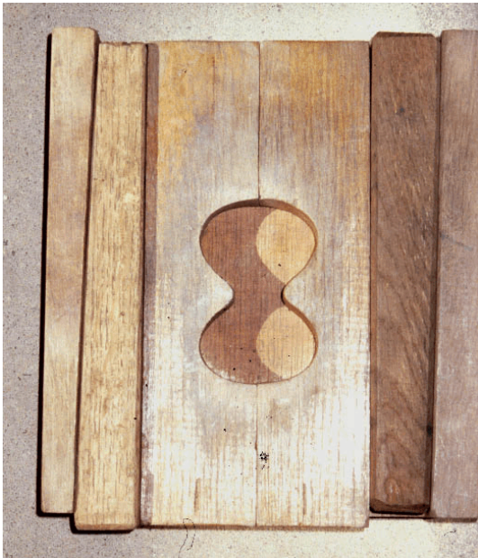
Abb. 6 Form für zur Bindekraftprüfung
