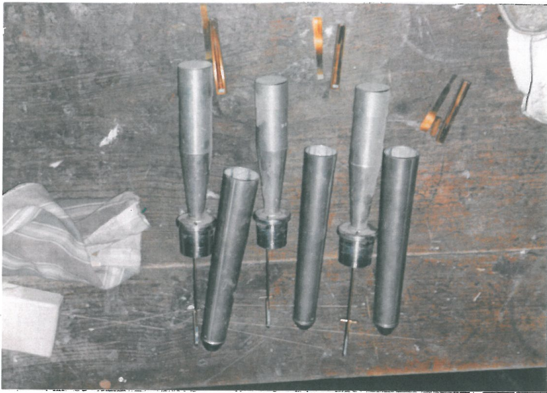
409.3 Korrosion an Kehlen, Zungen, Stimmkrücken und Nüssen des Zungenregisters Dulcian 16' (Kleinpedal)
