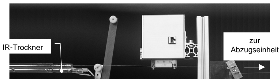
Abbildung 12 Einbau des Kapazitivsensors zwischen Trockner und Abzugseinheit
